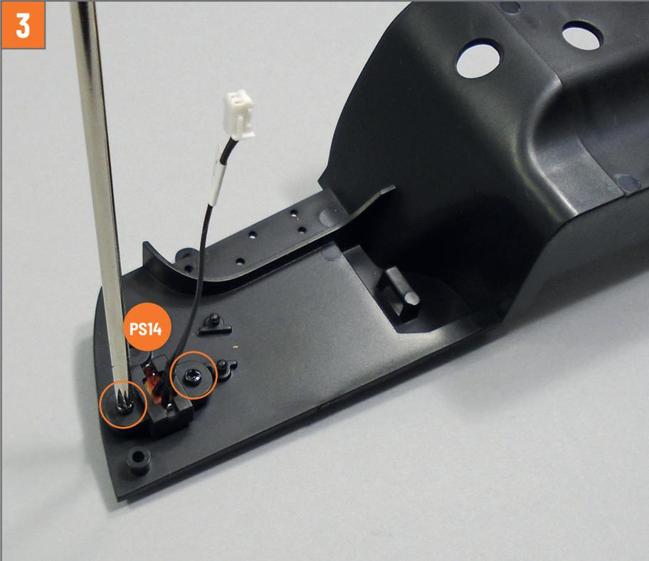
Befestigen Sie die Teile, indem Sie zwei Schrauben **PS14** in den auf dem Foto durch Kreise markierten Löchern festziehen.
