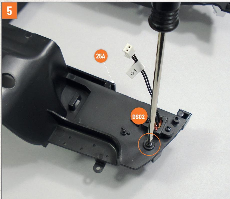
Prüfen Sie, ob das Loch im vorderen Teil des Radkastens mit dem entsprechenden Loch im vorderen Rahmensegment **25A** ausgerichtet ist. Befestigen Sie den Radkasten am Rahmensegment, indem Sie eine Schraube **DS02** in dem oben genannten Loch festziehen.
