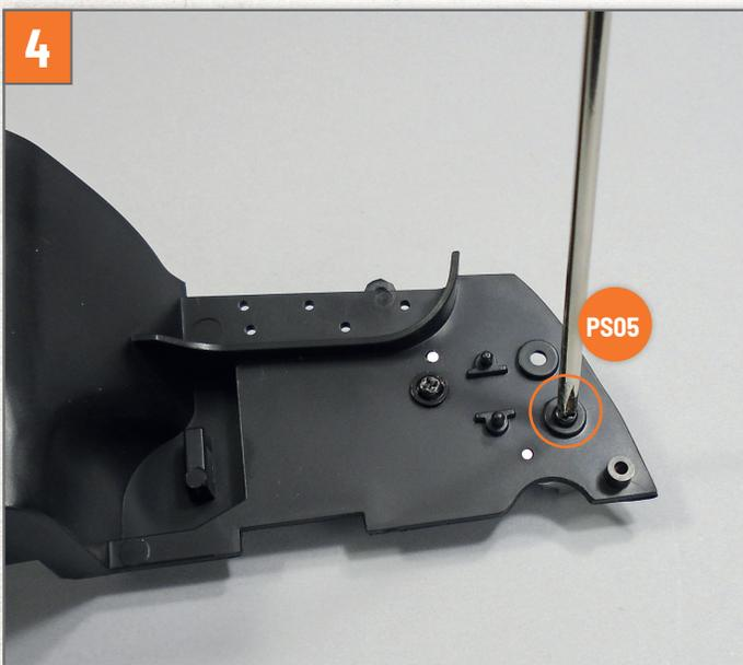
Befestigen Sie das Lenkgetriebe an der Oberseite des Radkastens mit einer Schraube **PS05**.
