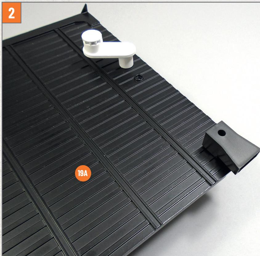
Nehmen Sie das Bodenblech Ihres Modells zur Hand. Montieren Sie die Wagenheberaufnahme in der auf dem Foto gezeigten Stelle an der Unterseite des Mittelteils **19A**.
