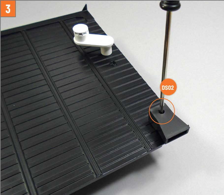
Ziehen Sie eine Schraube **DS02** in dem auf dem Foto gezeigten Loch fest, um die Teile aneinander zu befestigen.
