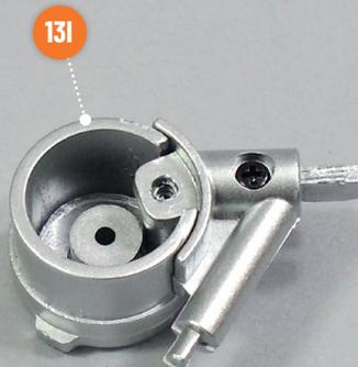
Befestigen Sie den Lichtmaschinenträger an der Vorderseite der Lichtmaschine **131**. Richten Sie die Teile wie abgebildet aus und prüfen Sie, ob ihre Löcher übereinstimmen.
