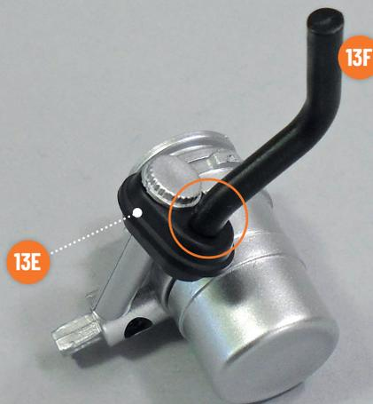
Stecken Sie den Stift am Ende des Entlüftungsschlauchs **13F** in das halbmondförmige Loch an der Vorderseite des Öleinfüllstutzens **13E**.
