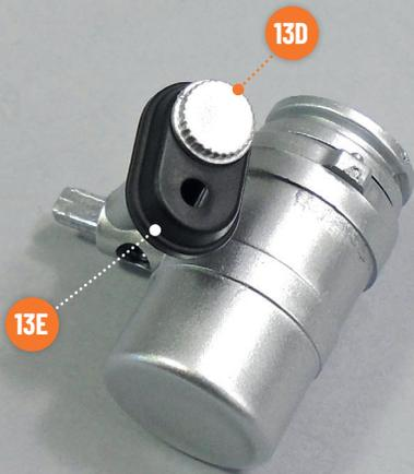
Montieren Sie den Deckel **13D** auf der Vorderseite des Öleinfüllstutzens **13E**. Die Stifte des Deckels haben zwei unterschiedliche Durchmesser und das Bauteil kann nur in einer einzigen Position eingebaut werden.
