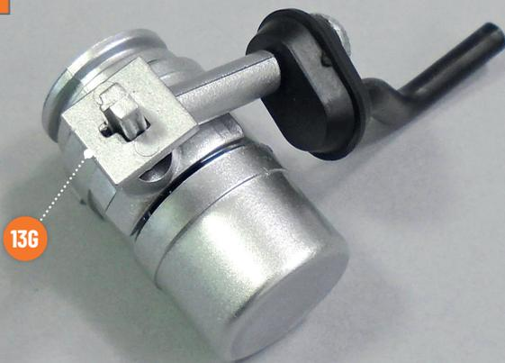
Montieren Sie die Platte **13G** auf den größeren Stift des Lichtmaschinenträgers. Richten Sie die Teile wie auf dem Foto gezeigt aus.
