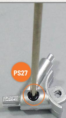
Befestigen Sie die beiden Teile des Lichtmaschinenträgers mit einer Schraube **PS27**.
