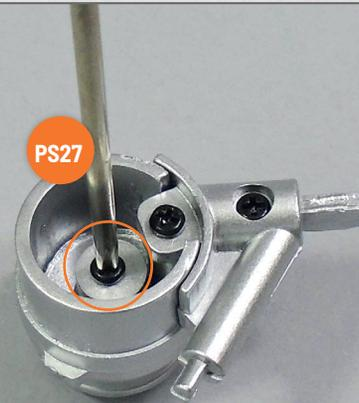
Drehen Sie die Lichtmaschine erneut um und befestigen Sie die Riemenscheibe mit einer Schraube **PS27** an der Baugruppe.
