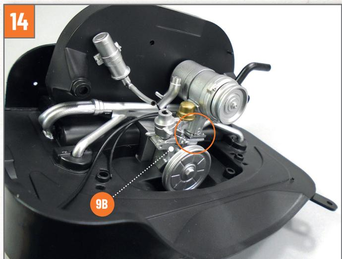
Stecken Sie den größeren Stift des Lichtmaschinenträgers in das entsprechende Loch auf der Frontplatte des Motors **9B** und richten Sie die Teile wie auf dem Foto gezeigt aus.
