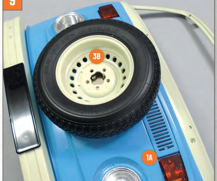
Setzen Sie das Rad so auf die Karosserie **1A**, dass die drei Löcher in der Außenfelge **3B** an den entsprechenden Löchern des Haltebügels ausgerichtet sind.
