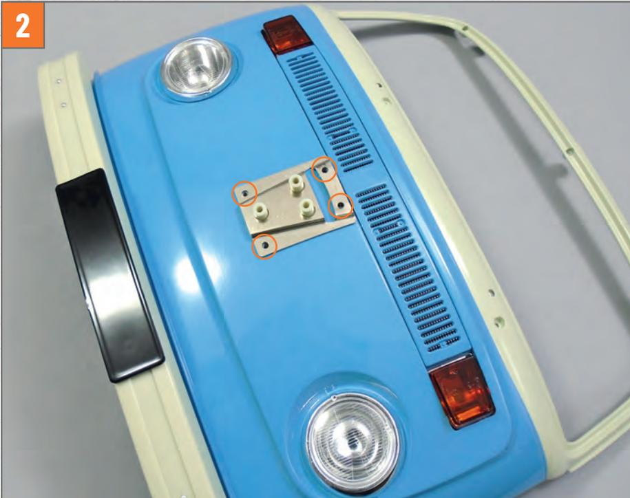
Nehmen Sie die Karosserie zur Hand und setzen Sie den Haltebügel mit der Platte wie auf dem Foto gezeigt auf.
