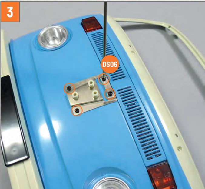
Befestigen Sie die Platte mit vier Schrauben **DS06** an der Karosserie.
