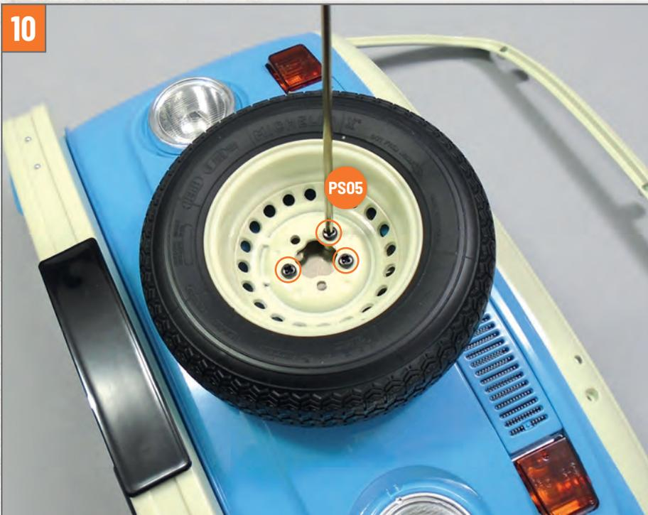
Befestigen Sie das Rad mit drei Schrauben **PS05** am Haltebügel.
