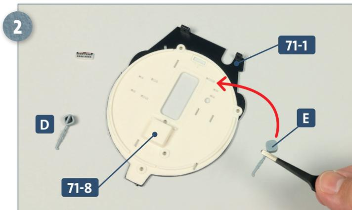
Das Anbauteil **71-8** ist am Schott **71-1** festgeklebt. Trennen Sie die beiden Abgasklappenventile aus dem Rahmen **71-7**. Versehen Sie den länglichen Zapfen des Ventils **E** mit Sekundenkleber und fügen Sie ihn in den Schlitz von **71-1** ein, wie es der Pfeil andeutet.
