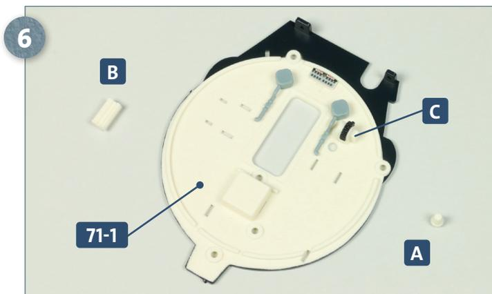
Versehen Sie die beiden Zapfen an der Rückseite von Teil **C** mit etwas Sekundenkleber und fügen Sie sie in die Schlitzte des Schotts **71-1** ein. Trennen Sie die Teile **A** und **B** aus dem Rahmen **71-5** heraus.
