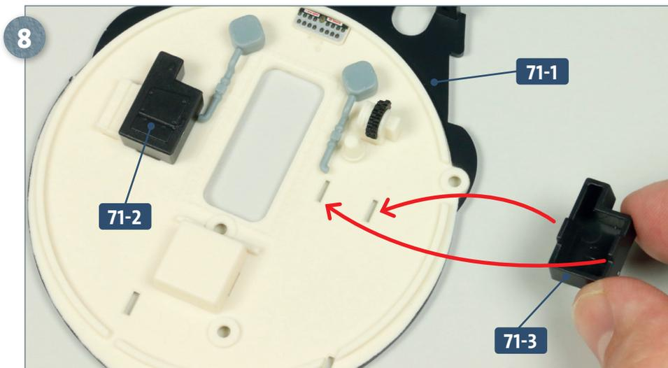
Nehmen Sie die beiden Anbauteile **71-2** und **71-3**. Kleben Sie sie links und rechts des Durchgangs am Schott **71-1** fest, wie es das Foto zeigt bzw. die Pfeile andeuten.
