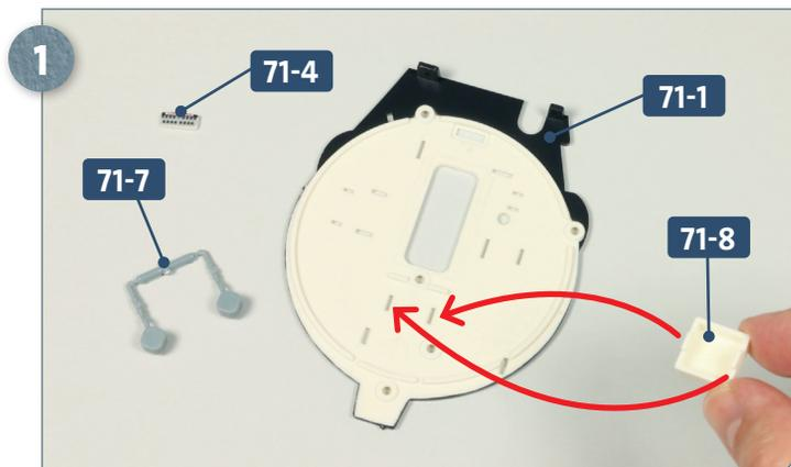
Legen Sie das achtere Dieselraumschott **71-1**, das Anbauteil **71-4** und die beiden Abgasklappenventile im Rahmen **71-7** bereit. Nehmen Sie das Anbauteil **71-8**, versehen Sie dessen zwei Zapfen mit Sekundenkleber und fügen Sie sie in die Schlitzte des Schotts ein.
