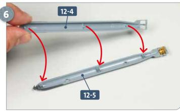
Versehen Sie die drei Zapfen der Torpedohälfte 12-4 mit etwas Sekundenkleber und fügen Sie sie in die entsprechenden Aufnahmen von 12-5 ein, wie es die Pfeile andeuten.
