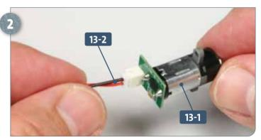
Den schmaleren Stecker am anderen Ende des Kabels 13-2 stecken Sie in die Buchse, die sich an der Platine des Motors 13-1 befindet.
