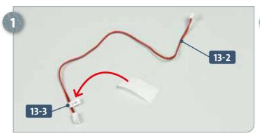
Lösen Sie die Kabelmarkierung 13-3 von der Trägerfolie und kleben Sie sie an dem Ende des Kabels 13-2 fest, an dem sich der breitere Stecker befindet.
