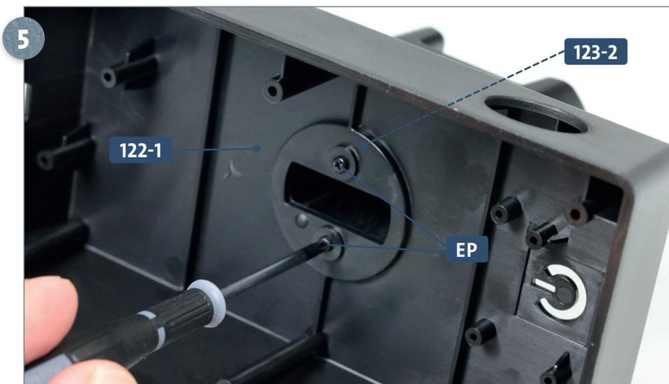
Halten Sie die Baugruppe auf dem vorderen Ständerkorpus **122-1** in Position und fixieren Sie die Trägersäule **123-2** von unten mit zwei Schrauben **EP**.
