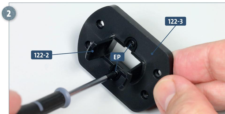
Befestigen Sie den Verbinder **122-2** an der Halterung **122-3**, indem Sie zwei Schrauben **EP** eindrehen.
