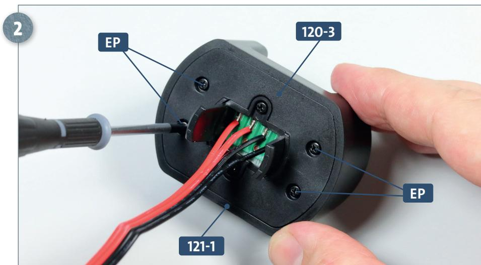
Die Unterseite **120-3** sitzt mit aufgesetztem Kontaktkabel in der Halterung **121-1** und wird an dieser mit vier Schrauben **EP** fixiert.
