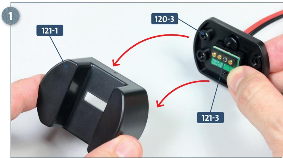
Nehmen Sie das Kontaktkabel **121-3** und führen Sie es durch die zentrale Öffnung in der Unterseite der Halterung **120-3** (Detailbild). Das Hauptbild zeigt die Endposition des Kontaktkabels **121-3**. Halten Sie das Kabel in Position, während Sie die Unterseite **120-3** von unten auf die Halterung **121-1** setzen, wie angedeutet.
