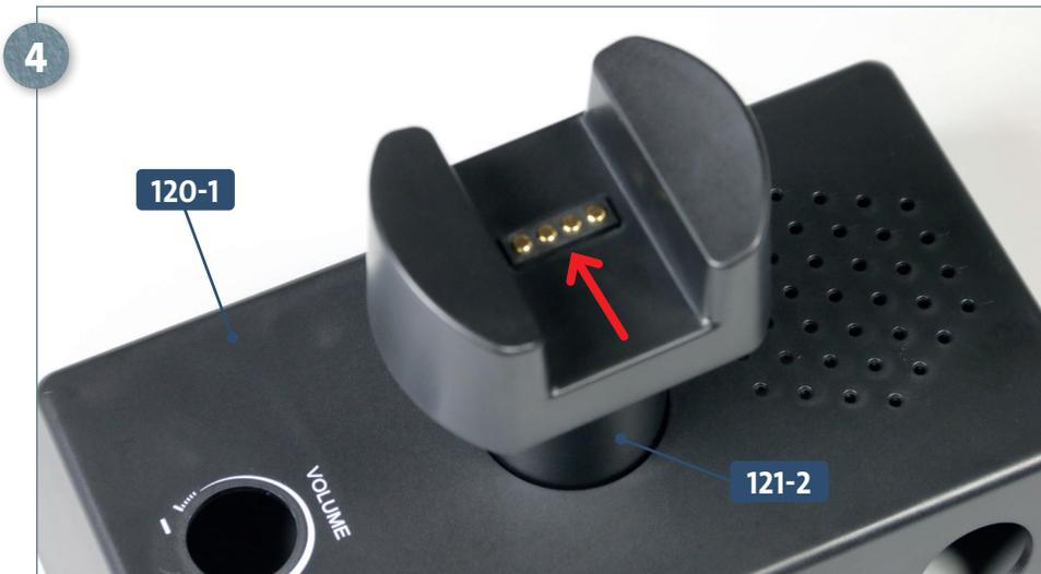
Führen Sie das Kontaktkabel **121-3** durch die längliche Öffnung im hinteren Ständerkorpus **120-1** (Detailbild). Platzieren Sie die Trägersäule **121-2** auf dem Ständerkorpus. Achten Sie dabei unbedingt darauf, dass sich die Öffnung für die Kontakte (Pfeil) nicht in der Mitte der Halterung befindet und so ausgerichtet werden muss, wie auf dem Foto abgebildet.
