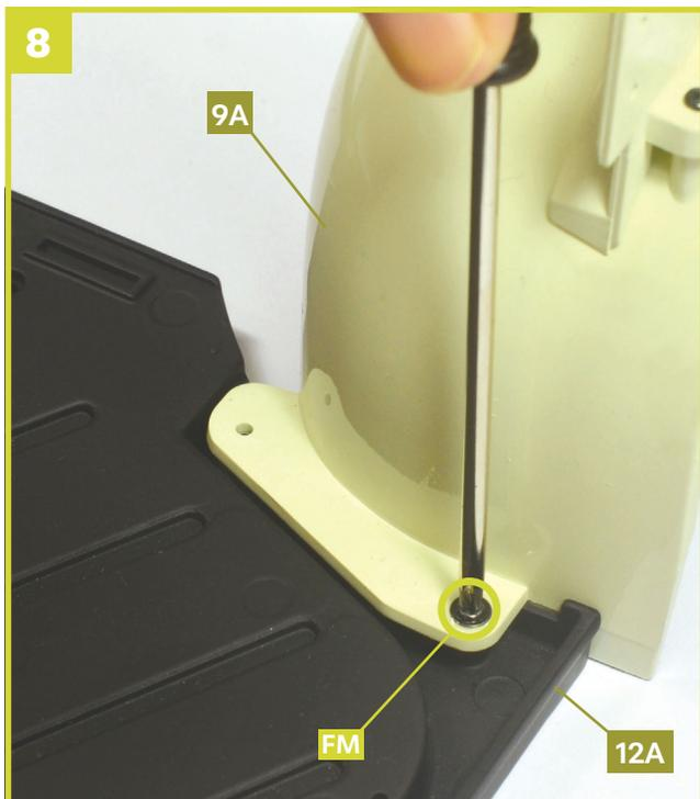
Ziehen Sie eine Schraube **FM** wie auf dem Bild gezeigt an, um den vorderen rechten Radkasten **9A** mit dem mittleren Bodenblech **12A** zu verbinden.
