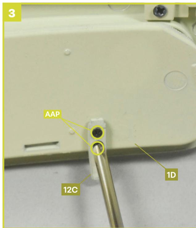
Fixieren Sie auch die rechte Schottwandhalterung **12C** mit zwei Schrauben **AAP** an der Schottwand **1D**, wie gezeigt.
