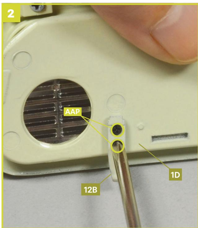
Fixieren Sie die linke Schottwandhalterung **12B** mit zwei Schrauben **AAP** an der Schottwand **1D**, wie gezeigt.
