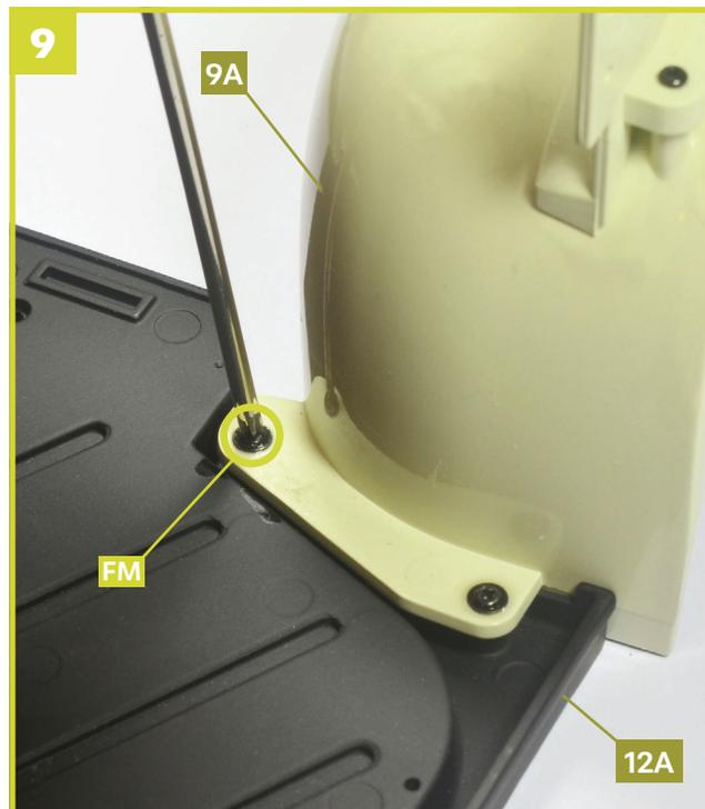
Schließen Sie die Montage des rechten vorderen Radkastens **9A** am mittleren Bodenblech **12A** ab, indem Sie eine weitere Schraube **FM** festziehen.
