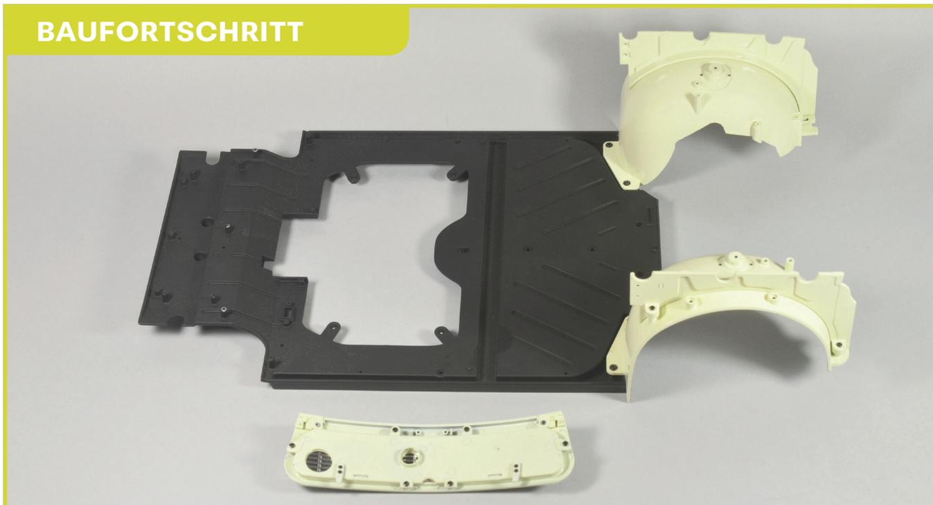
Die beiden vorderen Radkästen wurden am mittleren Bodenblech montiert. Bewahren Sie die Baugruppe sorgfältig auf, bis sie wieder benötigt wird.
