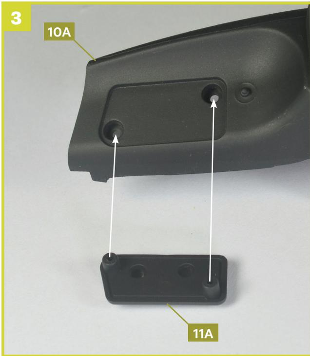
Achten Sie bei der Montage der Abdeckung für die Drehschalter **11A** (nächster Schritt) auf die korrekte Ausrichtung ihrer Zapfen, wie durch die Pfeile angedeutet.
