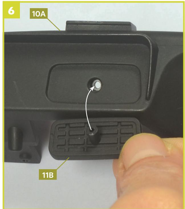
Setzen Sie den Zapfen der Blende **11B** wie durch den Pfeil angedeutet in die Instrumententafel.
