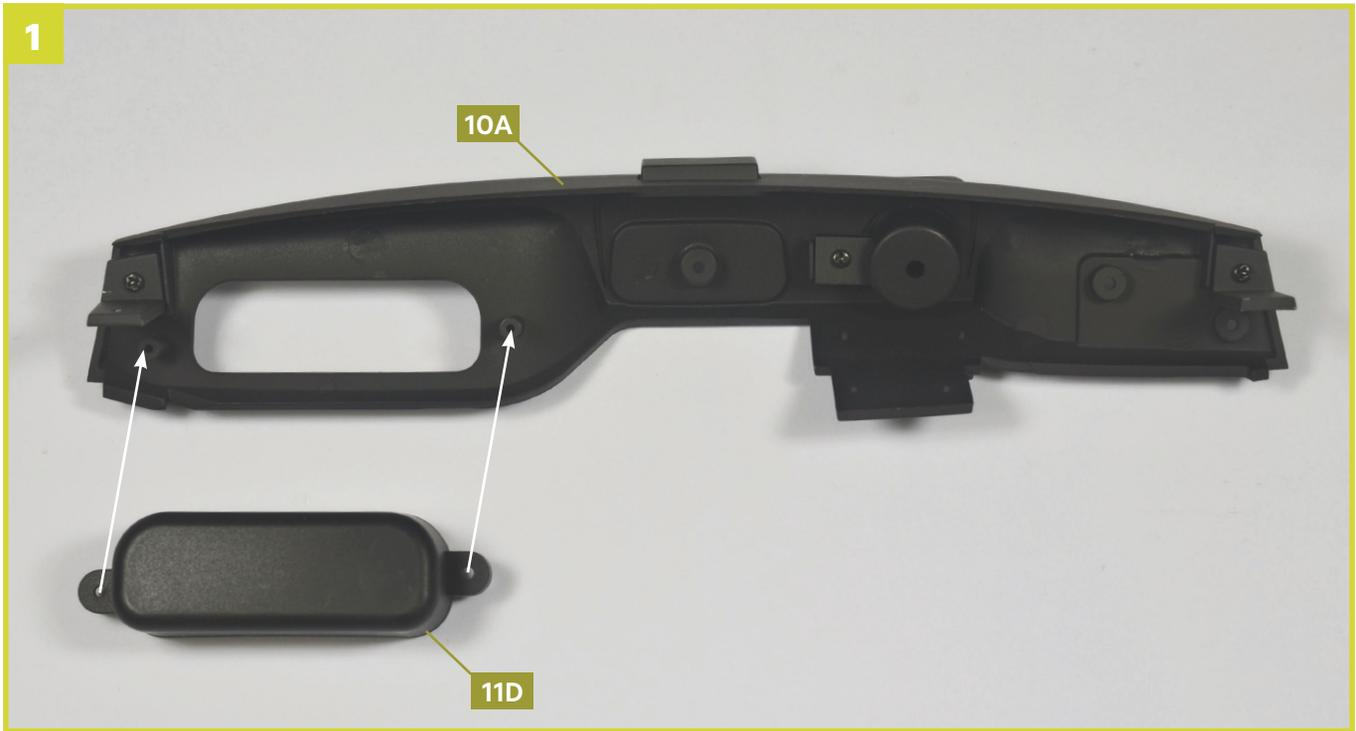
Nehmen Sie das Handschuhfach **11D** und positionieren Sie es wie durch die Pfeile angedeutet von innen an der Instrumententafel **10A**.
