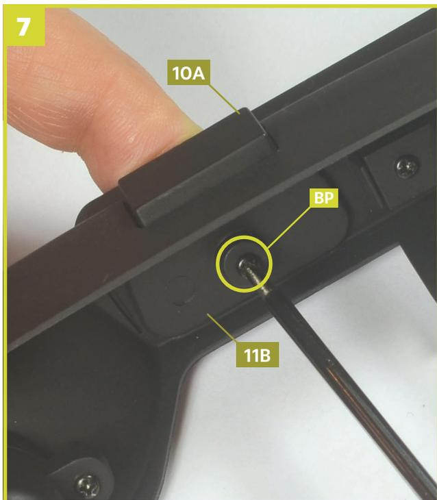
Fixieren Sie die Blende **11B** mit einer Schraube **BP**, die Sie von der Rückseite der Instrumententafel aus festziehen.
