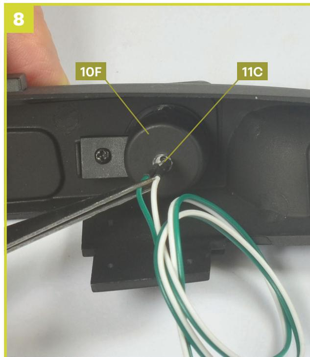
Setzen Sie die LED, welche sich am äußeren Ende des Kabels **11C** (E3) befindet, in die Öffnung in der Mitte des Tachometergehäuses **10F** ein, wie gezeigt.
