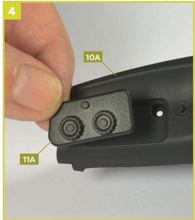
Setzen Sie nun die Abdeckung für die Drehschalter **11A** in die Vorrichtung am äußeren Ende der Instrumententafel **10A** ein.
