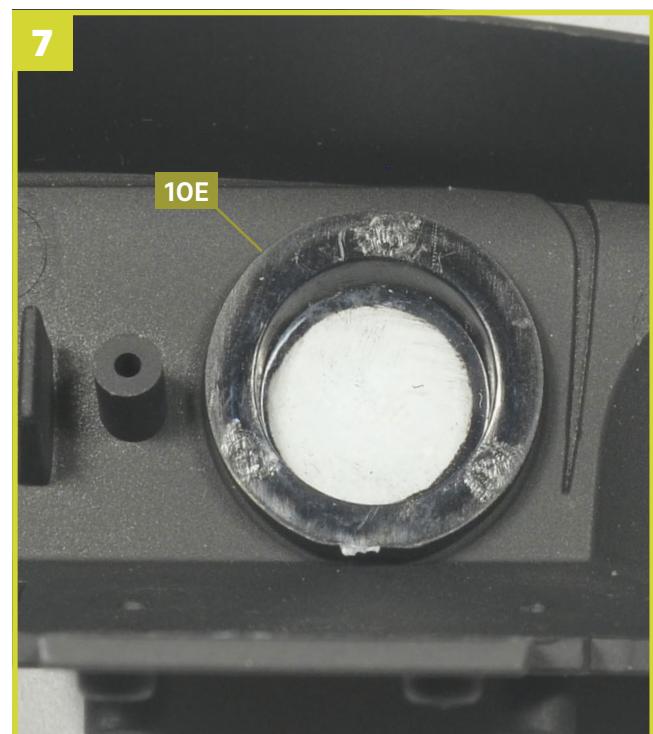
Das Bild zeigt die korrekt an der Instrumententafel angebrachte Tachometeranzeige 10E .
