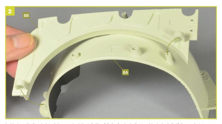
Positionieren Sie die gelochten Bohrungen des Seitenteils 8B auf die Zapfen des Radkastens 8A, wie durch die Pfeile angedeutet.
