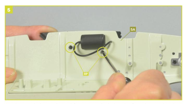
Verwenden Sie zwei Schrauben **BP**, um die Düse zu befestigen. Setzen Sie die Schrauben an der Außenseite der Spritzwand ein und ziehen Sie diese bis zum Anschlag fest.
