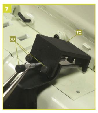
Stecken Sie die drei Bedienhebel für die Lüftung **7D** in die Düsenöffnungen. So wird die Stütze in ihrer Position festgehalten.
