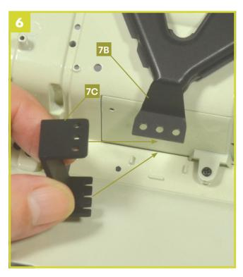
Positionieren Sie die Stütze **7C**, indem Sie sie an der Basis der Düse befestigen.
