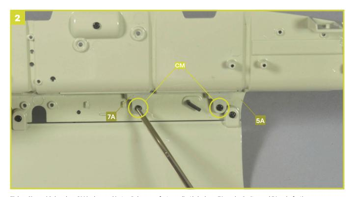
Ziehen Sie zwei Schrauben **CM** in den markierten Bohrungen fest, um die Abdeckung **7A** an der Spritzwand **5A** zu befestigen.
