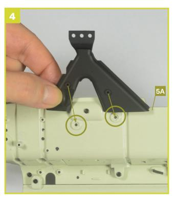
Positionieren Sie die Defrosterdüse auf der Spritzwand **5A** (Innenseite). Die beiden Pfeile zeigen Ihnen an, wie Sie die Düse befestigen müssen.
