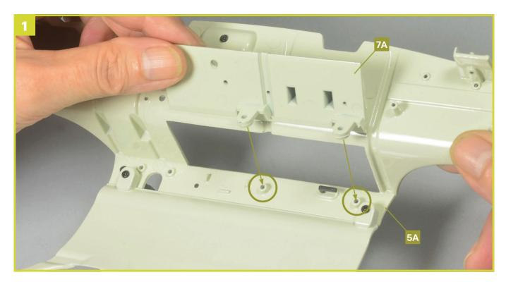
Nehmen Sie die Abdeckung **7A** und positionieren Sie sie an der Innenseite der Spritzwand **5A**. Richten Sie die rot markierten Montagevorrichtungen bündig auf den Stiften aus.
