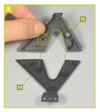
Verbinden Sie die beiden Hälften **7E** und **7B** der Defrosterdüse, indem Sie die Bohrungen der Hälfte **7E** auf die Zapfen von **7B** platzieren.
