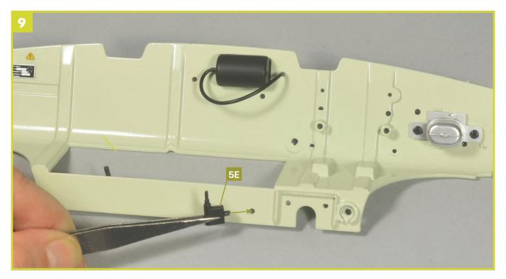
Nehmen Sie nun das Verbindungsstück **5E** und setzen Sie es in die Bohrung ein, auf die der Pfeil weist. Verwenden Sie ein wenig Klebstoff, falls notwendig.
