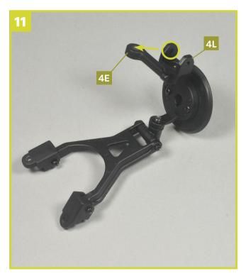
Drehen Sie die Federgabel (Schwenklager) **4L** so, dass ihre größere Bohrung (eingekreist) in Richtung der Öffnung des linken Schwenklagers **4E** weist, auf die der Pfeil zeigt.
