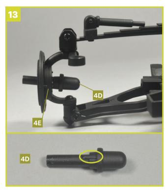
Setzen Sie den Radbefestigungsbolzen **4D** wie gezeigt in die Bohrung des Schwenklagers **4E** ein. Womöglich müssen Sie die Bohrung zuvor ausfeilen. Richten Sie den seitlichen Zapfen des Bolzens (unten eingekreist) an der Nut der Bohrung aus.
