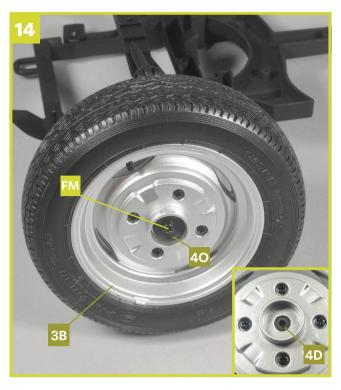
Stecken Sie das Rad von Ausgabe 3 auf den Bolzen **4D**, sodass er nahezu bündig zur Öffnung der Außenfelge **3B** sitzt (siehe Detailfoto). Setzen Sie den Abstandhalter **4O** in die Öffnung und fixieren Sie die Teile mit einer Schraube **FM**.
