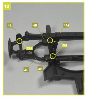
Befestigen Sie die beiden am Lenkerarm **4F** fixierten Stützen **4B** am Hilfsrahmen **4A**, indem Sie wie gezeigt je eine Schraube **EM** eindrehen (eingekreist). Fixieren Sie anschließend die Blattfeder **4M** mit einer Schraube **XM** an der Federgabel **4L**.
