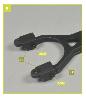
Nehmen Sie den linken Lenkerarm **4F** zur Hand und befestigen Sie an dessen beiden Streben je eine Aufhängungsstütze **4B** mit je einer Schraube **AOM**. Achten Sie darauf, die Schrauben wie auf dem Foto gezeigt einzusetzen.
