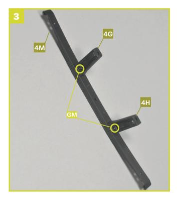
Legen Sie die Blattfeder **4M** mit der gestuften Seite nach unten vor sich. Fixieren Sie den linken Anschlagpuffer **4G** (mit **L** markiert) und den rechten Anschlagpuffer **4H** (mit **R** markiert) mit je einer Schraube **GM** an der Blattfeder, wie gezeigt.
