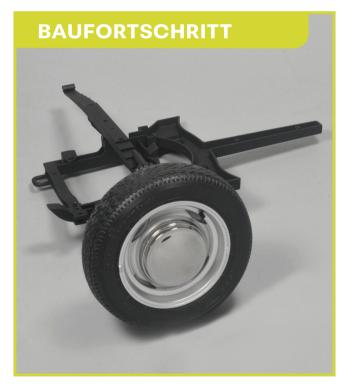
Am Ende dieser Bauphase haben Sie den ersten Teil des Hilfsrahmens montiert und das linke Vorderrad befestigt.
