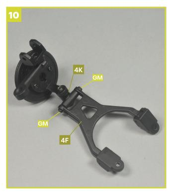
Setzen Sie die Schwenklagerstütze **4K** zwischen die kurzen Streben am schmalen Ende des Lenkerarms **4F**, sodass die Bohrlöcher fluchten. Schrauben Sie von jeder Seite eine Schraube **GM** ein, um die Teile miteinander zu verbinden.
