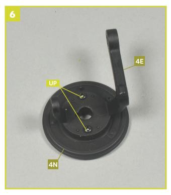
Positionieren Sie das linke Schwenklager **4E** und die Bremsankerplatte **4N** so, dass deren Bohrlöcher fluchten und der kleine Stift an der Rückseite von **4E** im Loch von **4N** sitzt. Verbinden Sie die Teile anschließend mit zwei Schrauben **UP**.
