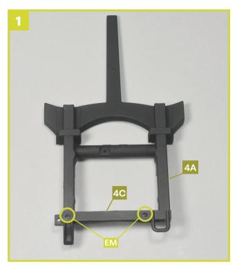
Legen Sie den Hilfsrahmen **4A** wie gezeigt vor sich und setzen Sie die Abschleppöse **4C** so auf den Rahmen, dass die Öse außen liegt. Fixieren Sie die beiden Teile aneinander, indem Sie zwei Schrauben **EM** an den eingekreisten Stellen festziehen.
