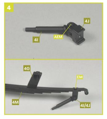
Verbinden Sie den Stoßdämpfer 4I und die Federgabel 4J (Blattfeder), indem Sie eine Schraube AEM vom größeren Loch der Federgabel aus eindrehen (oben). Fixieren Sie die Teile mit einer Schraube EM links an der Blattfeder 4M (unten).
