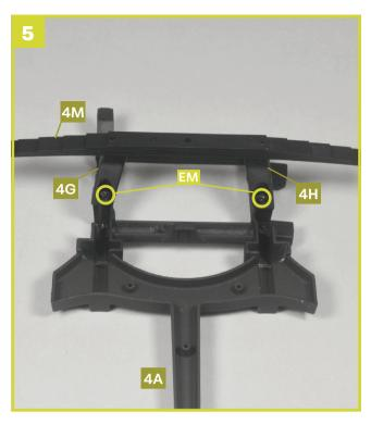
Legen Sie den Hilfsrahmen **4A** wie gezeigt vor sich und fixieren Sie daran die Anschlagpuffer **4G** und **4H**, die Sie mit Schritt 3 an der der Blattfeder **4M** befestigt haben, indem Sie je eine Schraube **EM** in den eingekreisten Stellen festziehen.
