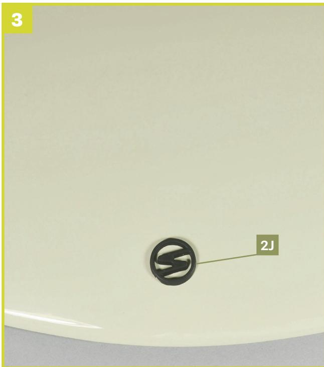
Setzen Sie die zwei Zapfen des Emblems **2J** in die zwei Löcher unten in der Motorhaube. Die Ausrichtung des Emblems ist durch die Stärke der Zapfen vorgegeben.
