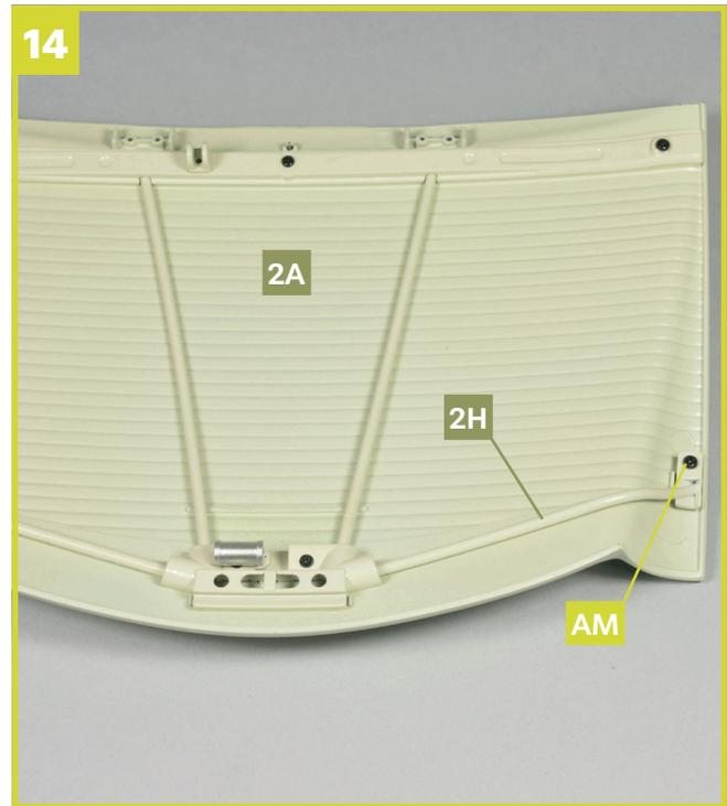
Gehen Sie genauso vor, um auf der anderen Seite die rechte seitliche Motorhaubenstrebe **2H** zu positionieren. Befestigen Sie sie abschließend mit einer Schraube **AM** an der Motorhaube **2A**.
