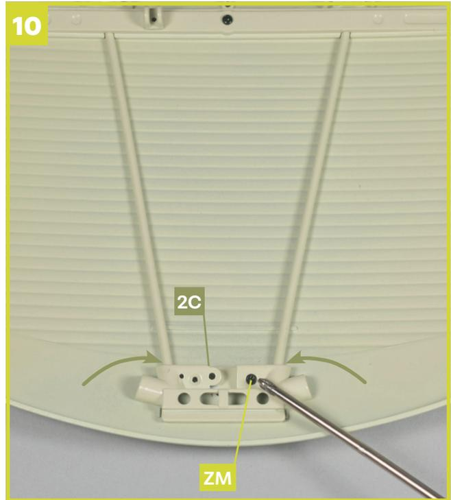
Platzieren Sie den Motorhaubenverschluss **2C** so auf der Motorhaube **2A**, dass die beiden Einkerbungen, auf die die Pfeile weisen, die zwei mittleren Motorhaubenstreben **2E** und **2F** aufnehmen. Ziehen Sie eine Schraube **ZM** wie gezeigt fest.
