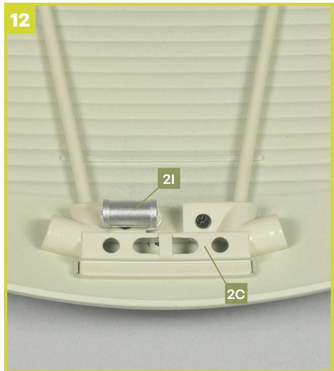
Setzen Sie die beiden Zapfen des Schnappschlosses **2I** wie gezeigt in die Löcher des Motorhaubenverschlusses **2C**. Die Ausrichtung ist durch die Stärke der Zapfen vorgegeben.
