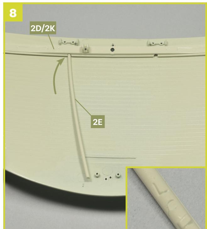
Nehmen Sie die linke mittlere Motorhaubenstrebe **2E** zur Hand, die mit einem eingravierten **L** gekennzeichnet ist, siehe Detailbild. Setzen Sie sie wie gezeigt in die Öffnung in der Querstrebe **2D/2K**, auf die der Pfeil weist.
