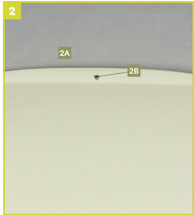
Drücken Sie die Zweistrahldüse **2B** in das obere Loch an der Außenseite der Motorhaube. Achten Sie dabei auf die korrekte Ausrichtung der Düse, wie auf dem Foto gezeigt.
