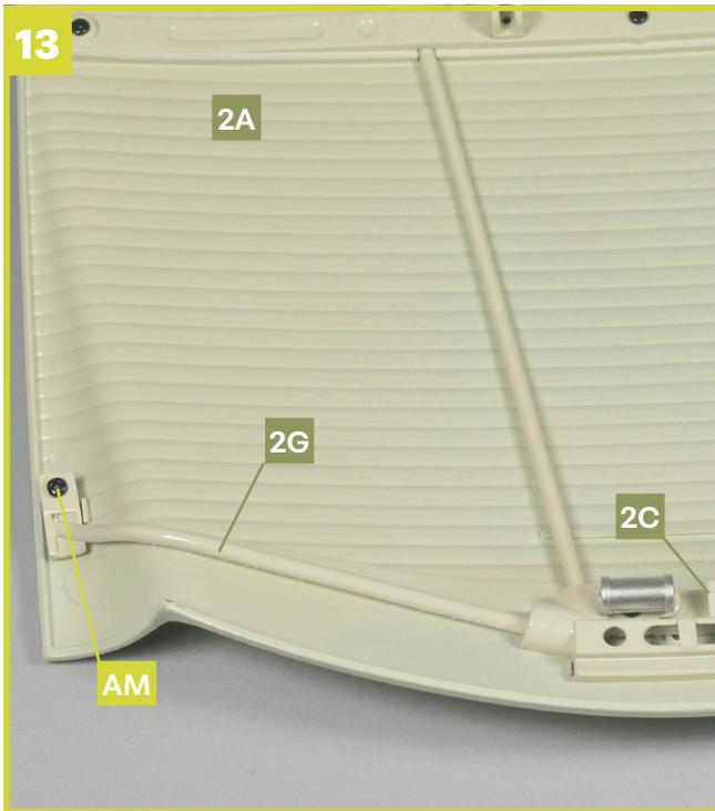
Führen Sie das schmale Ende der linken seitlichen Motorhaubenstrebe **2G** in die gezeigte Öffnung des Motorhaubenschlusses **2C**. Fixieren Sie das flache Ende der Strebe mit einer Schraube **AM** an der Motorhaube **2A**.
