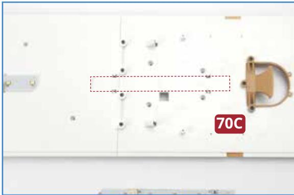
**8** Drehen Sie das Promenadendeck vorsichtig auf den Kopf. Bringen Sie den LED-Streifen **74C** an der Unterseite des zweiten (**69A**) und dritten (**70C**) Decksabschnitts an. Der Bereich ist links gekennzeichnet. Dazu schieben Sie die eine Längsseite des Streifens unter die beiden Laschen (unten rot eingekreist), während Sie die andere Kante einrasten lassen, indem Sie die dortigen Laschen mit einem flachen Schraubenzieher leicht zur Seite drücken (unten blau eingekreist).
