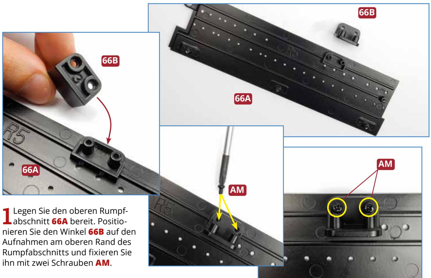
**1** Legen Sie den oberen Rumpfabschnitt **66A** bereit. Positionieren Sie den Winkel **66B** auf den Aufnahmen am oberen Rand des Rumpfabschnitts und fixieren Sie ihn mit zwei Schrauben **AM**.
