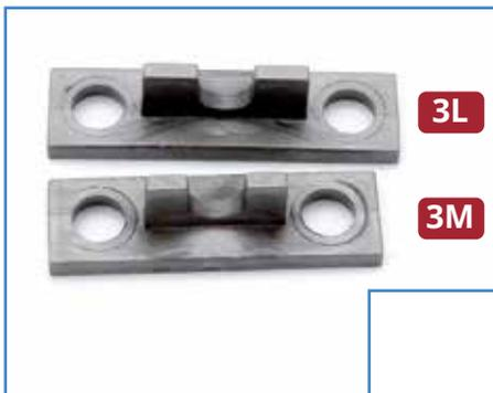
**7** Die vier Halterungen sollen die Kurbelwelle in Position halten. Nehmen Sie die beiden oberen Halterungen **3L** und **3M**. Beachten Sie, dass die vordere Halterung **3L** länger ist. Die Löcher in den Halterungen nehmen die jeweils zwei Zapfen an den Enden des Gehäuses auf. Die Enden der Kurbelwelle **3R** ruhen in den halbrunden Vertiefungen der Halterungen **3L** und **3M**.
