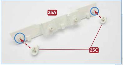
Legen Sie die Vorderwand **25A** bereit. Auf deren äußeren Aufnahmen (oben links, blau eingekreist) setzen Sie die zwei Verbinder **25C** (mit eingeprägtem B). Die Laschen/Einkerbungen stellen sicher, dass die Teile korrekt zueinander ausgerichtet werden. Fixieren Sie die Verbinder mit je einer Schraube **CP**
