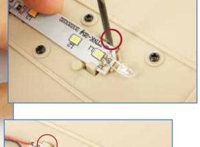
Fügen Sie die LED-Platine **25E** unter die kleinen Laschen an der Unterseite des C-Decks **12A** ein (oben, blau eingekreist). Mithilfe eines Schlitzschraubendrehers oder einer Pinzette drücken Sie die anderen beiden Laschen leicht zur Seite (oben rechts, rot eingekreist), sodass die LED-Platine sicher unten den vier Laschen sitzt (rechts, rot und blau eingekreist).
