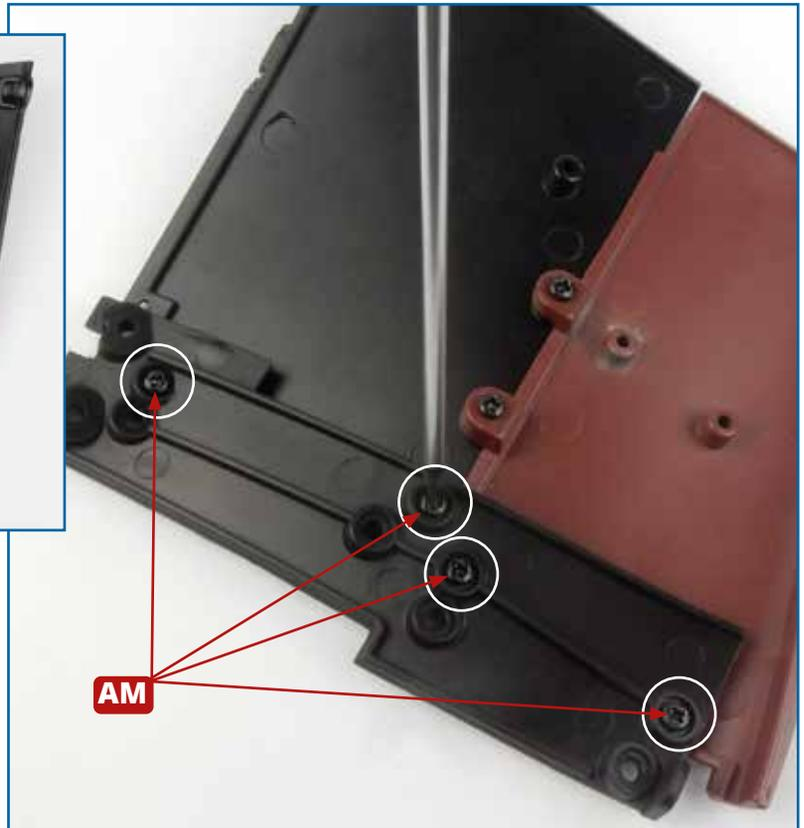
**2** Die Verbindungsplatte **2D** stärkt den Halt zwischen den Bugteilen **2A** und **2B** und dient zudem als Befestigungspunkt für die folgenden Rumpfbauerteile. Platzieren Sie die Platte so auf den Bugteilen, dass sich die Bohrungen über den Aufnahmen befinden (oben). Fixieren Sie die Platte mit vier Schrauben **AM** (rechts eingekreist).
