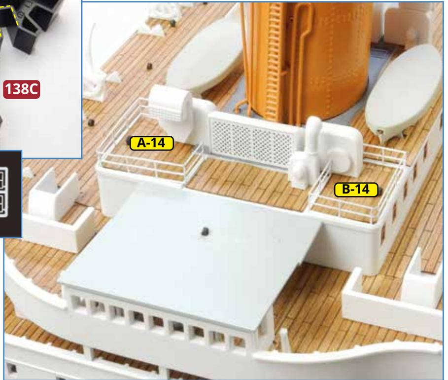
**9** Trennen Sie die Relings **A-14** und **B-14** aus dem Ersatzteil-Rahmen **138L** heraus. Biegen Sie die Relings mithilfe der Winkel **C** und **D** der Schablonen **138C**, **138D** und **138E**. Prüfen Sie den Sitz der Relings und kleben Sie sie an der Struktur vor dem vordersten Schornstein fest.
