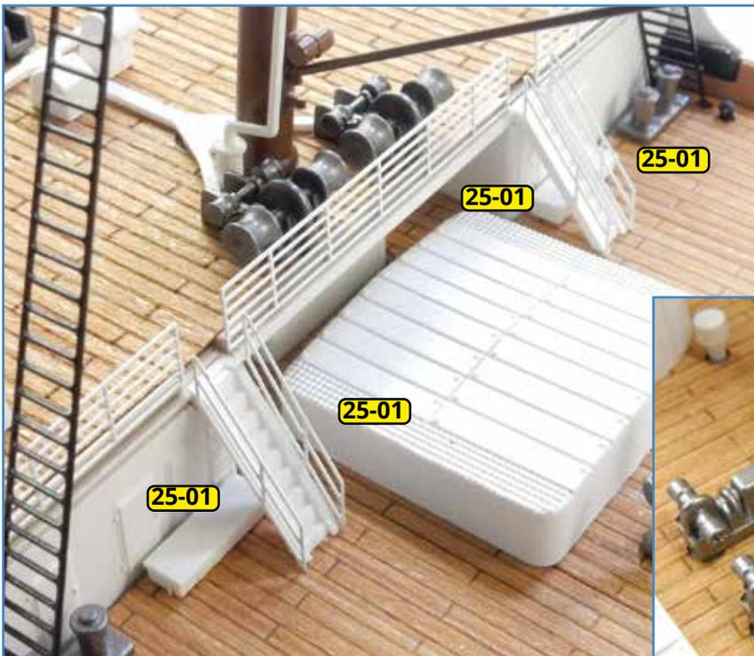
**8** Trennen Sie die vier Handläufe **25-01** aus dem Rahmen und kleben Sie sie an den beiden Niedergängen fest, die vom Vorderdeck zum vorderen C-Deck führen. Am achteren Ende des vorderen C-Decks werden an dem Niedergang, der zum B-Deck hinaufführt, zwei Handläufe **136-01** angebracht.
