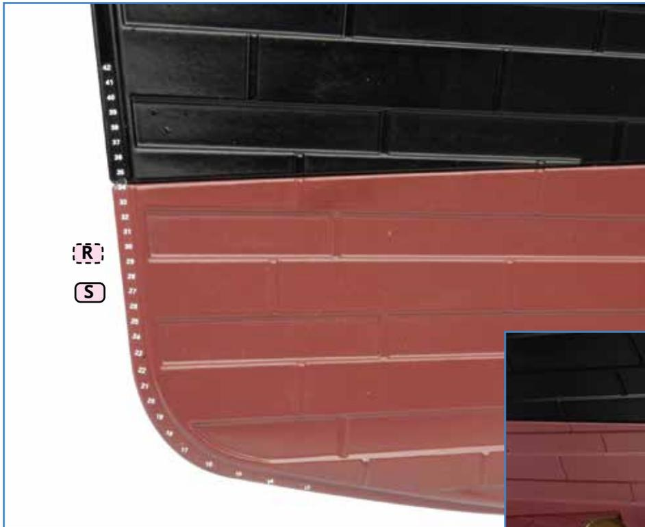
**13** Schneiden Sie die Decals **S**, **R** (Bug) und **N** (Heck) aus dem Decalbogen **138J** aus. Lösen Sie die Decals nacheinander ab und kleben Sie sie entlang des Vorderstevens bzw. neben dem Ruder fest. Es ist vielleicht einfacher, wenn Sie die Decals in zwei Hälften schneiden und zuerst den oberen Teil und dann den unteren Teil anbringen.
