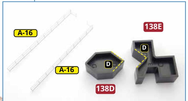
**10** Trennen Sie die beiden Relings **A-16** aus dem Rahmen **138K** heraus und biegen Sie sie mithilfe des Winkels **D** der Schablonen **138D** und **138E**. Achten Sie darauf, das richtige Ende zu biegen: Hier ist der Abstand zwischen den Pfosten etwas geringer als am anderen Ende. Kleben Sie die beiden Relings beiderseits des obersten Decks im Bereich zwischen den beiden vordersten Schornsteinen fest.
