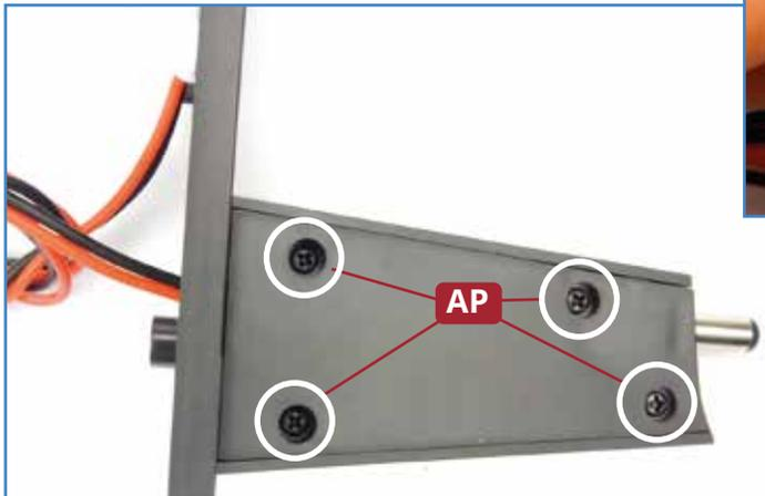
**2** Nehmen Sie die Abdeckung **102B** und setzen Sie sie so auf die Stütze **101A**, dass auch die andere Hälfte des Halses vom Kabelkontakt sicher umschlossen wird (oben). Befestigen Sie die Abdeckung, indem Sie vier Schrauben **AP** eindrehen (links).
