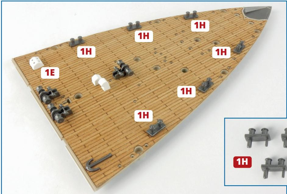
**3** Als Nächstes sind die sechs Poller **1H** und das kleine Oberlicht **1E** an der Reihe. Sie werden entlang der beiden Außenseiten des Vorderdecks positioniert und vorsichtig in die entsprechenden Bohrungen gedrückt. Ihre Ausrichtung ist durch die unterschiedlichen Zapfengrößen vorgegeben.
