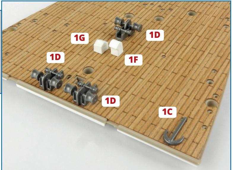
**2** Nehmen Sie den Anker **1C**, die drei Dampfspills **1D** und die Entlüftungsschächte **1F** und **1G**. Sie werden allesamt im hinteren Bereich des Vorderdecks angebracht. Vergewissern Sie sich, dass sie korrekt ausgerichtet sind. Es handelt sich um Steckverbindungen – kein Klebstoff wird benötigt.
