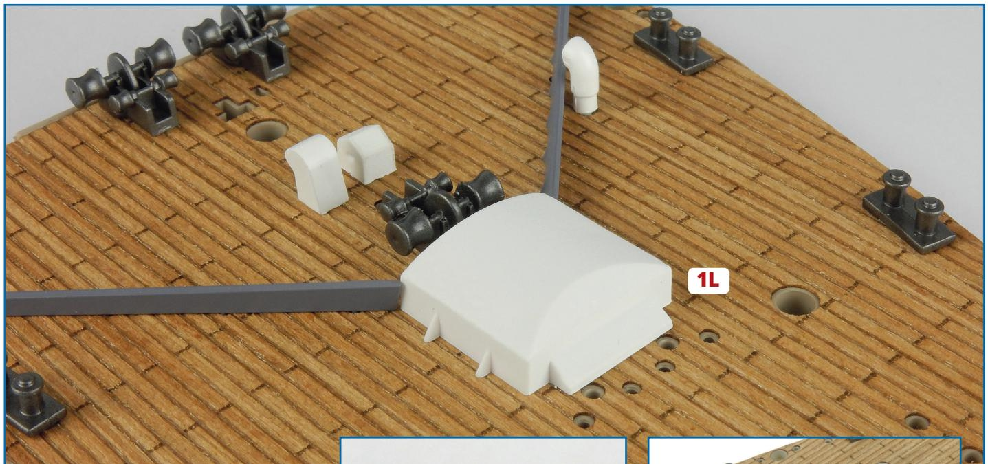
**5** Befestigen Sie die Ladelupe **1L** vor den beiden Wellenbrechern auf dem Vorderdeck. Drücken Sie dazu ihre beiden Zapfen in die Löcher hinein, die auf dem Bild ganz rechts eingekreist sind. Sitzt die Ladelupe zu locker, versehen Sie den Rand der beiden Löcher mit etwas Sekundenkleber.
