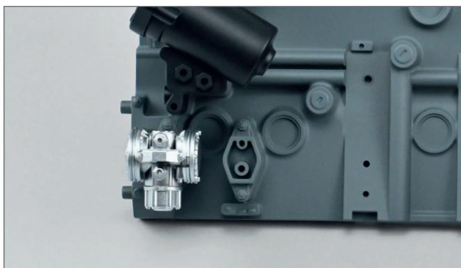
**17** ▶ Vergleichen Sie anhand des Fotos, ob Sie die erste Kraftstoffpumpe korrekt eingebaut haben.
