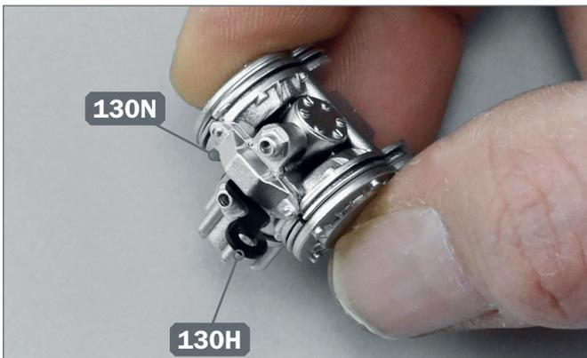
**9** ▶ Bringen Sie eines der Teile 130N an der Vorderseite der Kraftstoffpumpe an und richten Sie die Teile wie auf dem Foto gezeigt aus. Führen Sie die Lasche eines Verbindungselements 130H in die Öffnung des Bauteils.
