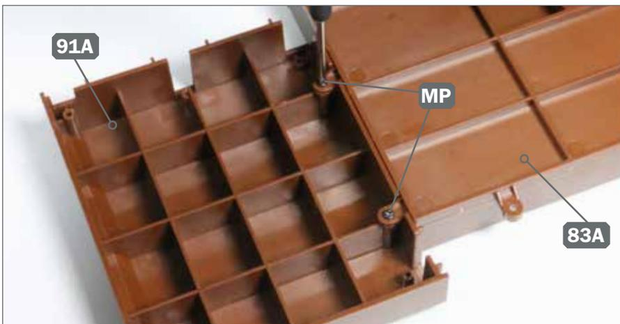
**2** ► Fixieren Sie die beiden Bodenteile 83A und 91A aneinander, indem Sie zwei Schrauben MP eindrehen, wie abgebildet.
