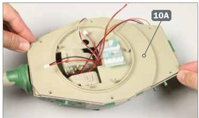
**6** ▶ Setzen Sie die Baugruppe mit der Bodenplatte 10A auf den Turm. Führen Sie die sechs Kabel durch die große Aussparung der Bodenplatte, wie abgebildet.
