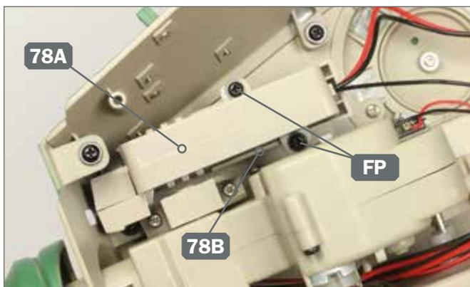
**5** ▶ Befestigen Sie die Kameraeinheit 78A mit zwei Schrauben FP an der Halterung 78B.
