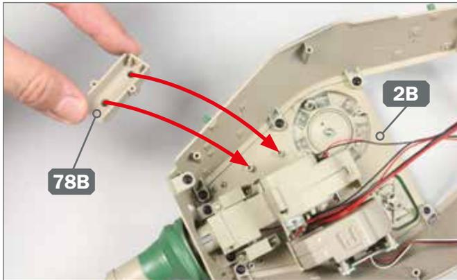
**1** ▶ Legen Sie den Turm verkehrt herum auf Ihre Arbeitsplatte. Führen Sie die Halterung 78B zu den Schraubenaufnahmen am Turmdach 2B, auf die die Pfeile weisen.
