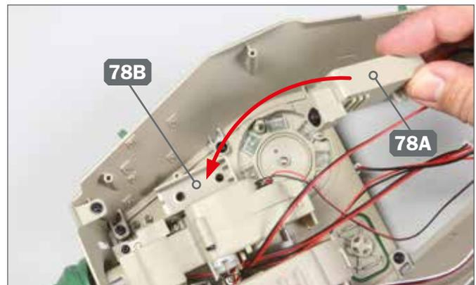
**4** ▶ Richten Sie die Kameraeinheit 78A aus, wie abgebildet, und führen Sie sie zur Halterung 78B, wie es der Pfeil andeutet.
