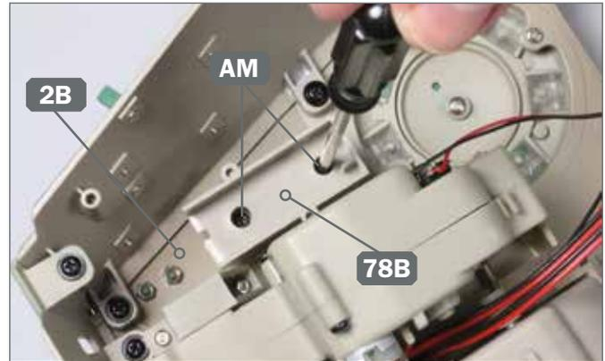
**2** ▶ Fixieren Sie die Halterung 78B mit zwei Schrauben AM am Turmdach 2B.
