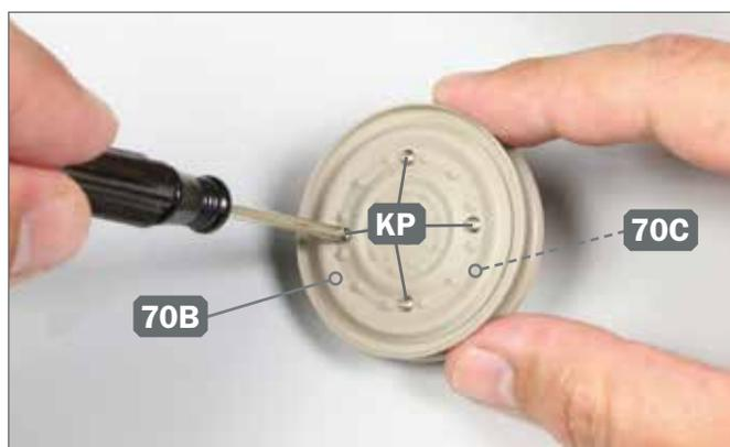
**6** ► Fixieren Sie die beiden Laufrad-Baugruppen 70B und 70C aneinander, indem Sie die vier Schrauben KP an der Außenseite des inneren Laufrads eindrehen.
