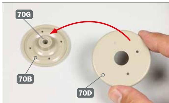
**4** ► Die Manschette 70G ist in der Nabe des Laufrads 70B platziert. Nehmen Sie die Lochscheibe 70D und setzen Sie sie auf das innere Laufrad, wie angedeutet.
