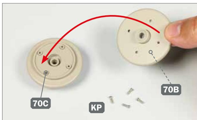
**5** ► Fügen Sie die beiden Laufrad-Baugruppen 70B und 70C zusammen, wie angedeutet. Legen Sie vier Schrauben KP bereit.
