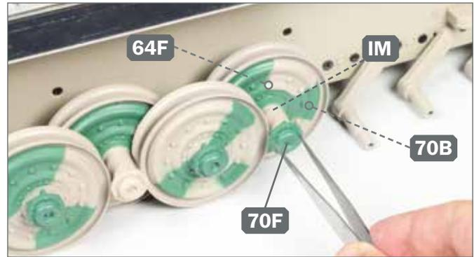
**8** ▶ Befestigen Sie das Laufrad 70B mit der Schraube IM am Achsschenkel 64F. Setzen Sie den Nabendeckel 70F an der Nabe des Laufrads auf.
