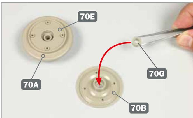
**3** ► Die Lochscheibe 70E liegt auf der Lochscheibe 70A. Führen Sie die Manschette 70G zur Nabe an der Innenseite des inneren Laufrads 70B.
