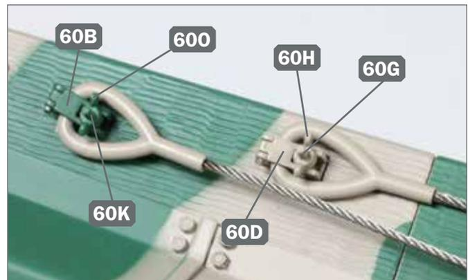
**4** ▶ Sichern Sie die Kauschen des Abschleppseils 61B in den Halterungen. Klappen Sie dazu die Verschlüsse 60B und 60D zu und drehen Sie eine Flügelmutter 600 bzw. 60H an den Stiftschrauben 60K bzw. 60G fest.
