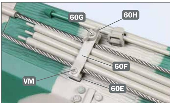
**3** ▶ Sichern Sie die Putzstöcke, indem Sie auf der Halterung 60E den Verschluss 60F anbringen. Fixieren Sie ihn mit einer sandgelben Schraube VM und drehen Sie eine Flügelmutter 60H an der Stiftschraube 60G fest.
