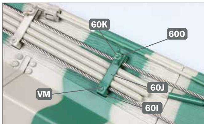
**4** ▶ Gleiches Prozedere an der Halterung 60I: Legen Sie den Verschluss 60J auf, sichern Sie ihn mit einer olivgrünen Schraube VM und ziehen Sie eine Flügelmutter 600 an der Stiftschraube 60K fest.
