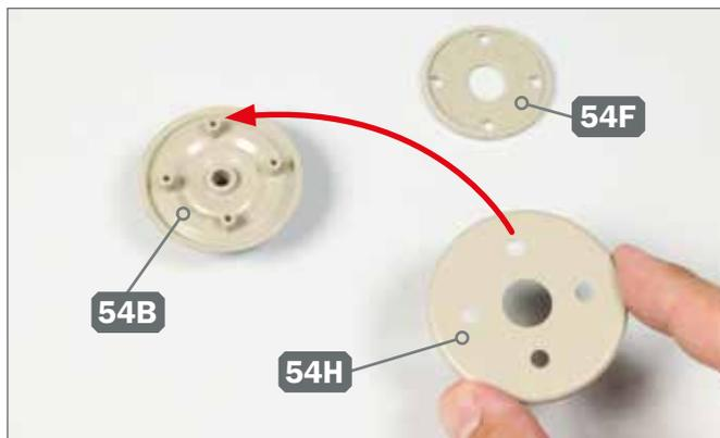
**1** ► Legen Sie die Lochscheibe 54F bereit. Nehmen Sie die Lochscheibe 54H und platzieren Sie sie auf der Innenseite vom äußeren Laufrad 54B, wie angedeutet.
