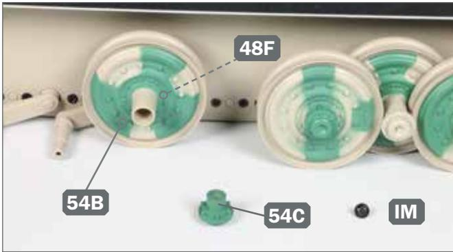
**7** ▶ Legen Sie den Nabendeckel 54C und eine Schraube IM bereit. Setzen Sie das Laufrad 54B auf den sechsthintersten Achsschenkel 48F.
