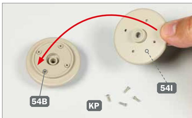
**5** ► Fügen Sie die beiden Laufrad-Baugruppen 54I und 54B zusammen, wie angedeutet. Legen Sie vier Schrauben KP bereit.
