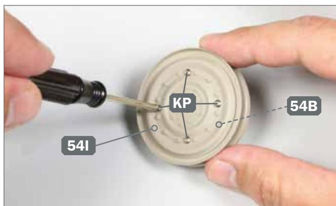
**6** ► Fixieren Sie die beiden Laufrad-Baugruppen 54I und 54B aneinander, indem Sie die vier Schrauben KP an der Außenseite des inneren Laufrads eindrehen.
