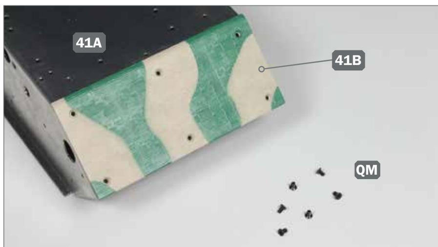
**2** ► Die Frontabdeckung 41B ist korrekt auf der Unterwanne 41A platziert, wenn die Bohrungen beider Teile übereinstimmen, wie abgebildet. Legen Sie sechs Schrauben QM bereit.
