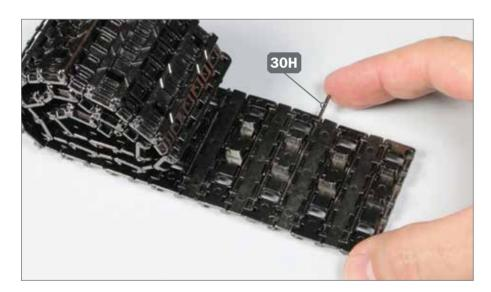
Verbinden Sie den aktuellen viergliedrigen Kettenabschnitt mit der Restkette, indem Sie den Stift 30H durch die Bohrungen führen, wie es das Foto zeigt.
