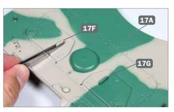
Als Nächstes werden die beiden Griffe 17F und 17G auf der Panzerwanne 17A festgeklebt, und zwar in den Bohrungen der Funker- bzw. Fahrerluke.
