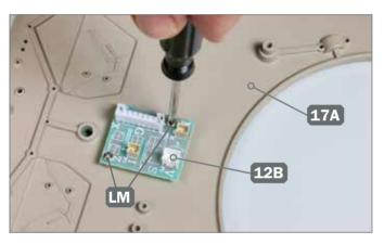
3 > Befestigen Sie die Platine 12B mit zwei Schrauben LM am Oberteil der Panzerwanne 17A.
