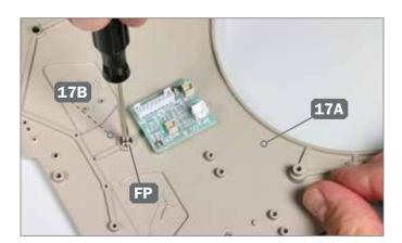
5 ► Befestigen Sie die Belüftungsabdeckung 17B, mit einer Schraube FP, die Sie von der Unterseite aus in die Bohrung der Panzerwanne 17A eindrehen.
