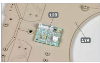
Die Platine 12B ist korrekt auf der Unterseite vom Oberteil der Panzerwanne 17A aufgesetzt.
