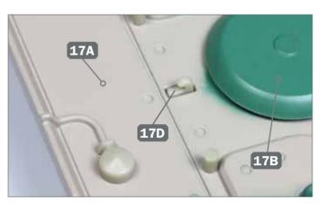
10 ➤ Zuletzt wird der Haken 17D, ausgerichtet wie abgebildet, vor der Belüftungsabdeckung 17B auf der Panzerwanne 17A festgeklebt.
