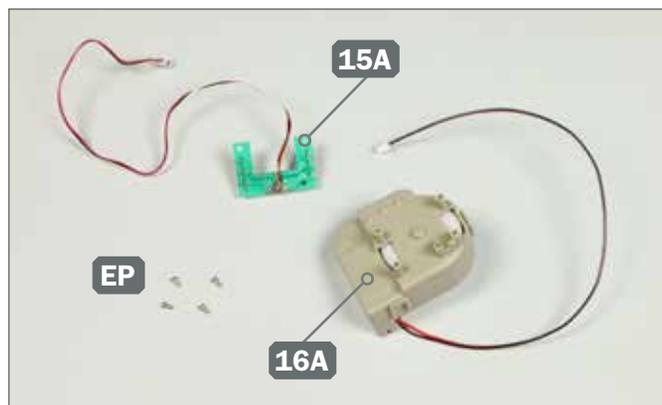
**4** ▶ Legen Sie das Höhenrichtgetriebe 16A, die Platine 15A und vier Schrauben EP aus der Ausgabe 15 auf Ihrer Arbeitsplatte bereit.
