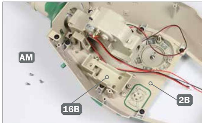
**2** ▶ Die Halterung 16B ist korrekt an der Unterseite des Turmdachs 2B aufgesetzt. Legen Sie drei Schrauben AM bereit, wie abgebildet.
