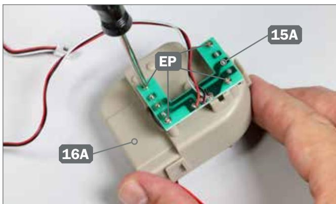
**5** ▶ Setzen Sie die Platine 15A auf das Höhenrichtgetriebe 16A und fixieren Sie sie mit den vier Schrauben EP.
