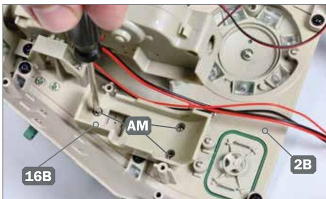
**3** ▶ Befestigen Sie die Halterung 16B mit den drei Schrauben AM am Turmdach 2B.
