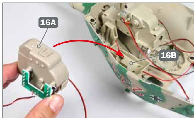
**6** ▶ Richten Sie das Höhenrichtgetriebe 16A aus, wie abgebildet, und führen Sie es zur Halterung 16B, wie es der Pfeil andeutet.
