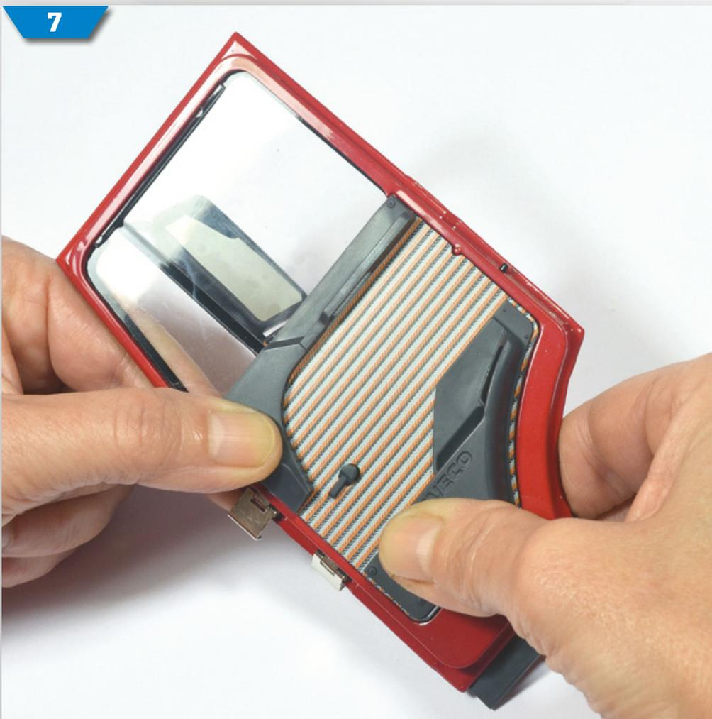
**7** Setzen Sie zunächst die beiden Laschen an der kürzeren Seite der Türverkleidung in die entsprechenden Schlitze der Tür ein. Schieben Sie anschließend die beiden Laschen an der langen Seite der Türverkleidung in ihre Schlitze. Achten Sie darauf, den Seitenspiegel nicht zu beschädigen. Üben Sie leichten Druck aus, um die Teile zu befestigen.
