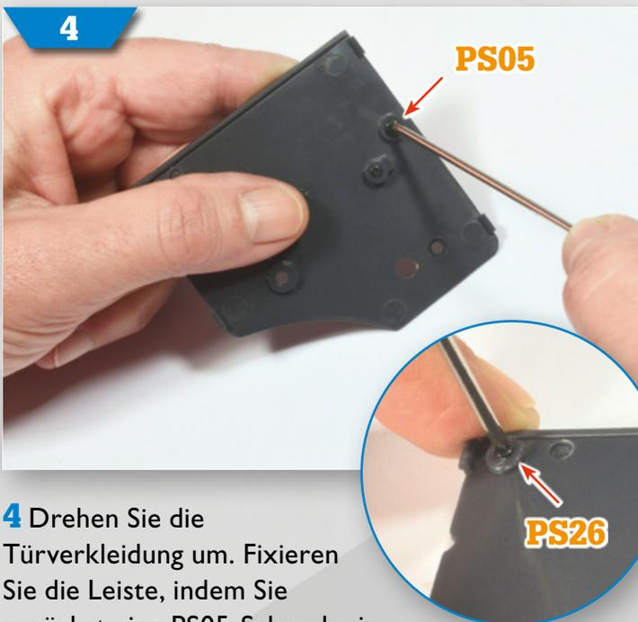
**4** Drehen Sie die Türverkleidung um. Fixieren Sie die Leiste, indem Sie zunächst eine PS05-Schraube in dem Loch anziehen, auf das der Pfeil im rechteckigen Foto weist. Drehen Sie dann eine PS26-Schraube in der im runden Foto gezeigten Ecke der Türverkleidung ein.
