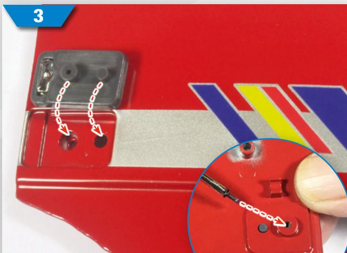
**3** Bringen Sie das Türschloss an der gezeigten Stelle an der Außenseite der rechten Tür an. Befestigen Sie es mit einer PS12-Schraube.
