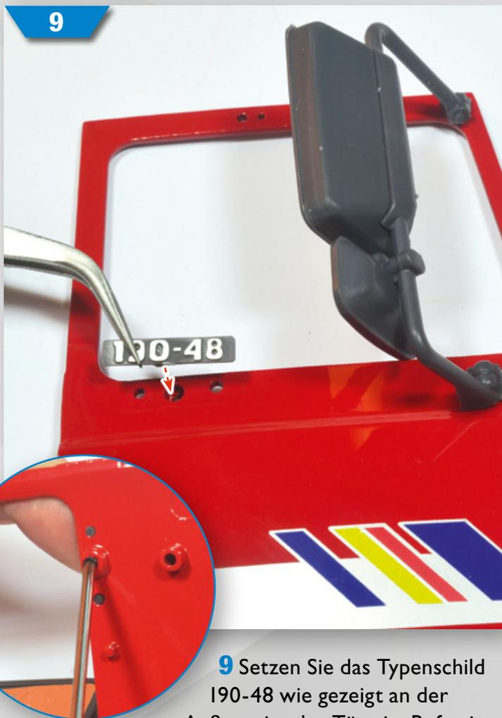
**9** Setzen Sie das Typenschild 190-48 wie gezeigt an der Außenseite der Tür ein. Befestigen Sie es mit einer PSI2-Schraube.
