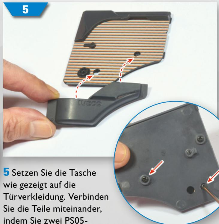
**5** Setzen Sie die Tasche wie gezeigt auf die Türverkleidung. Verbinden Sie die Teile miteinander, indem Sie zwei PS05-Schrauben von der Rückseite der Türverkleidung aus eindrehen.
