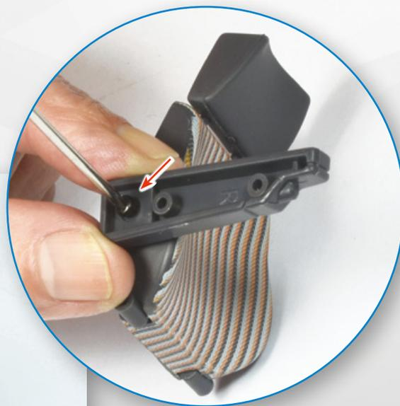
**3** Bringen Sie den inneren Teil der rechten Armlehne (mit „R“ gekennzeichnet) wie gezeigt rechts am Rahmen der Rückenlehne an, indem Sie sein Loch in den gebohrten Zapfen einsetzen. Befestigen Sie die Teile mit einer PS05-Schraube, aber ziehen Sie sie nicht ganz fest: Die Armlehne muss sich noch verstellen lassen.
