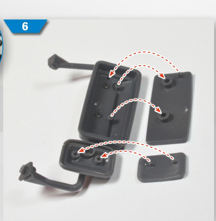
**6** Richten Sie den kleinen und großen Glashalter an jeweils passenden Spiegel aus und setzen Sie die Teile wie angedeutet zusammen.
