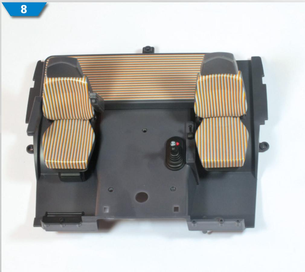
**8** So sieht der Kabinenboden nach dem Einbau des Beifahrersitzes aus.
