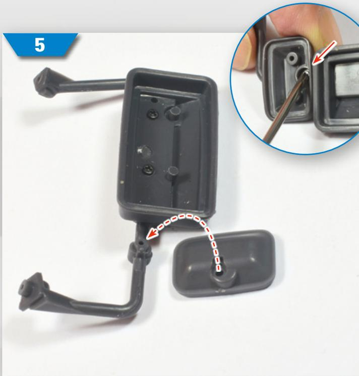
**5** Montieren Sie unter dem großen Spiegel auch den kleinen Seitenspiegel an der Halterung. Befestigen Sie den Spiegel mit einer PS05-Schraube.
