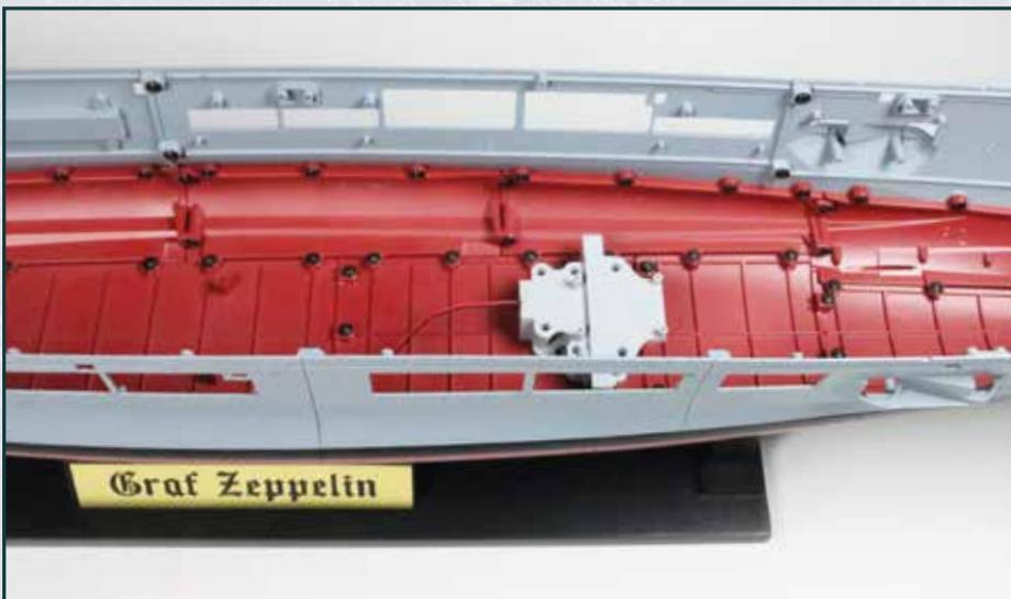
Der Antriebsmotor ist in das Getriebegehäuse eingesetzt, das Getriebe zusammengesetzt und verschlossen.
