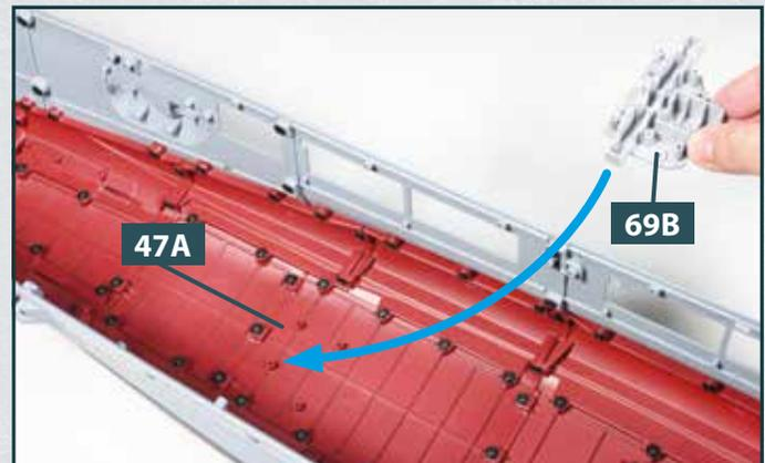
**4** Positionieren Sie die Rumpfstruktur (mit dem Heck nach links) auf Ihrer Arbeitsplatte. Setzen Sie das Getriebegehäuse **69B** so in die Struktur ein, dass seine vier flachen Schraubenaufnahmen die vier Zapfen des Kielabschnitts **47A** umfassen.
