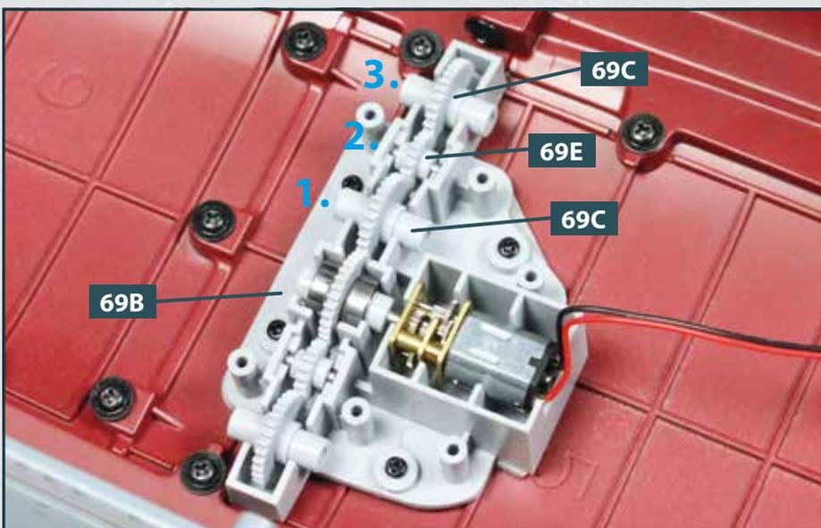
**11** Auf der anderen Seite vom Motor werden folgende drei Zahnräder in der genannten Reihenfolge in das Getriebegehäuse **69B** eingesetzt: zunächst ein großes Zahnrad **69C** (1.), dann das verbliebene kleine Zahnrad **69E** (2.) und zuletzt das verbliebene Zahnrad **69C** (3.).
