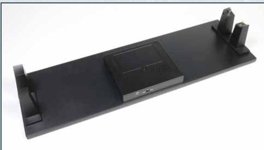
**Der Lautsprecher wurde auf der Unterseite des Batteriefachs eingesetzt, vier Kabel sind mit der Ein-/Aus-Platine verbunden. Das Batteriefach ist an der Bodenplatte des Ständers befestigt.**
