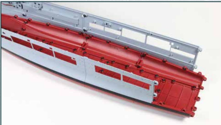
Der Kielabschnitt ist in die Rumpfstruktur eingefügt und an dieser verschraubt.
