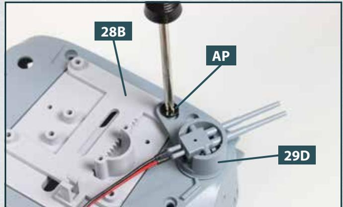
**4** Befestigen Sie den Arm der Lafette **29D** mit einer Schraube **AP** an der Trägerplatte **28B**. Achten Sie darauf, die Schraube nicht zu fest anzuziehen!
