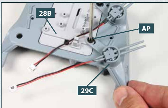
**9** Befestigen Sie den Arm der Lafette **29C** mit einer Schraube **AP** an der Trägerplatte **28B**. Achten Sie erneut darauf, die Schraube nicht zu fest anzuziehen.
