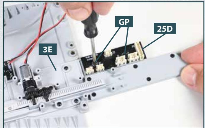
**2** Befestigen Sie die Platine **25D** mit zwei Schrauben **GP** am Katapult-Unterbau **3E**.
