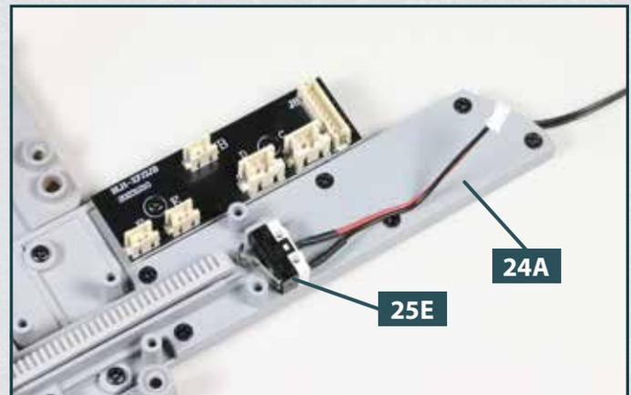
**4** Drücken Sie den Sensor **25E** an den beiden Zapfen der Abdeckung **24A** fest. Es handelt sich um eine Steckverbindung.
