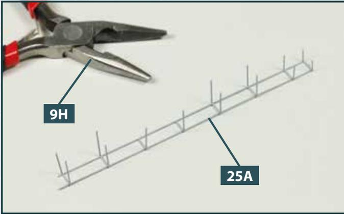
**3** Auch die Streben auf der anderen Seite von **25A** werden mit Hilfe der Flachzange **9H** rechtwinklig nach oben gebogen.
