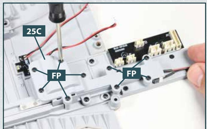
**6** Befestigen Sie die Motorabdeckung **25C** mit neun Schrauben **FP** an der Flugdeck-Baugruppe.
