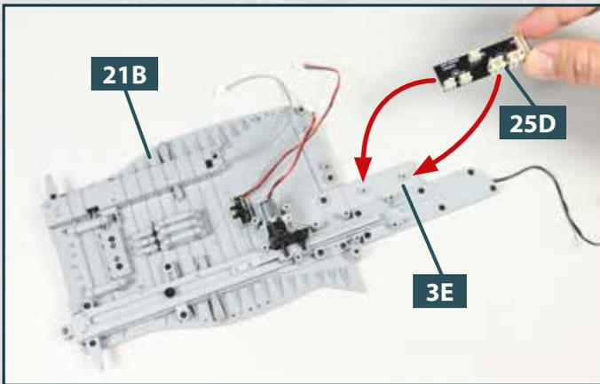
**1** Legen Sie die Baugruppe mit dem vordersten Abschnitt des Flugdecks **21B** mit der Oberseite nach unten bereit. Nehmen Sie die Platine **25D** und setzen Sie sie auf die Aufnahmen des Katapult-Unterbaus **3E**, wie es die Pfeile andeuten.
