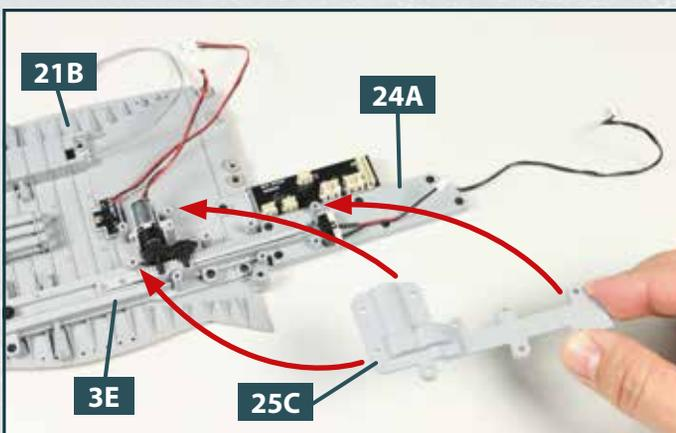
**5** Nehmen Sie die Motorabdeckung **25C** und platzieren Sie sie auf den Aufnahmen des Katapult-Unterbaus **3E**, des Flugdecks **21B** und der Abdeckung **24A**, wie es die Pfeile andeuten.
