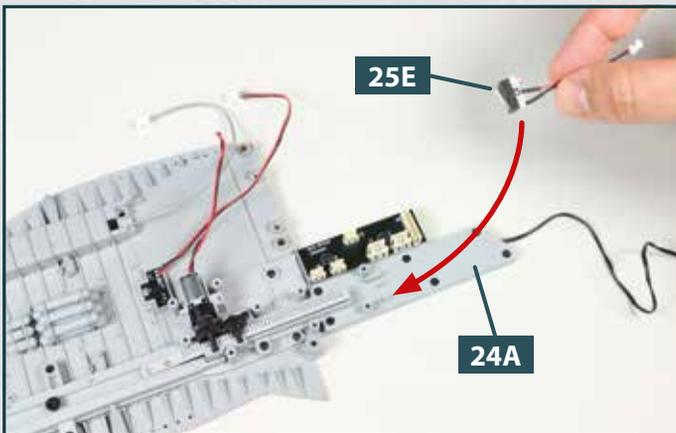
**3** Nehmen Sie den Sensor mit Kabel **25E** und führen Sie ihn zu den beiden Zapfen an der Abdeckung **24A**.
