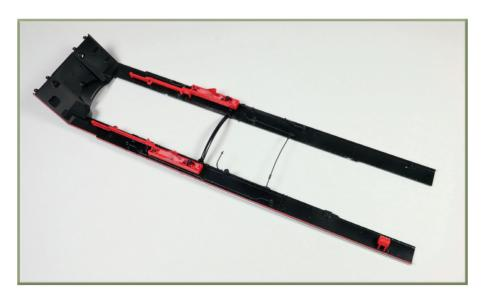
An der Unterseite des rechten Umlaufblechs wurden diverse Bauteile befestigt.
