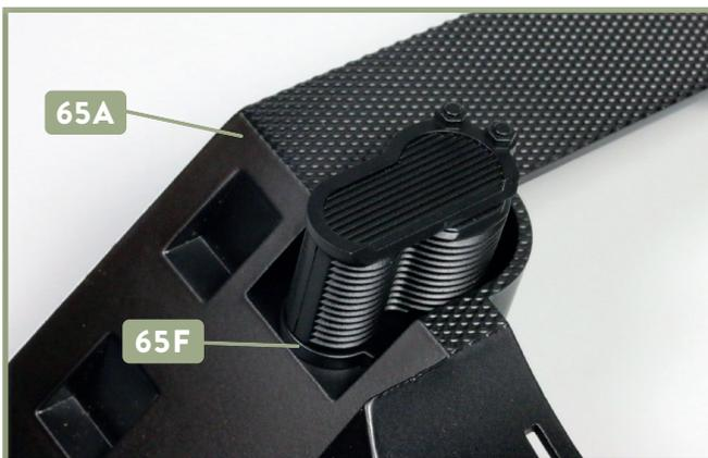
**5** Die Zapfen vom Bodenteil **65F** sind in die beiden Löcher der Frontverkleidung **65A** eingefügt: Die Luftpumpe ist fixiert.
