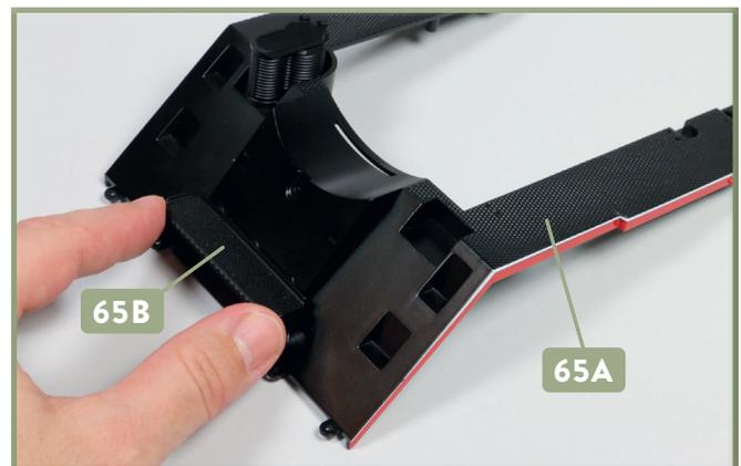
**6** Versehen Sie die drei Zapfen des Trittblechs **65B** mit Sekundenkleber und fügen Sie sie in die Löcher im unteren Bereich der Frontverkleidung **65A** ein.
