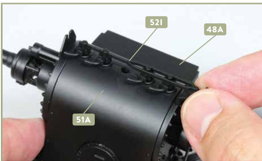
**13** Nehmen Sie die Zylinderhähne mit Bedienungsstange **52I** zur Hand. Drücken Sie deren vier Zapfen vorsichtig in die entsprechenden Bohrungen an der Unterseite der Verkleidungen **48A** und **51A** hinein. Es handelt sich um eine Steckverbindung.
