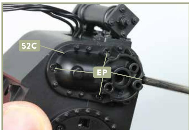
**7** Befestigen Sie die Basis des Schieberkastendeckels **52C** am Zylinderblock, indem Sie vier Schrauben **EP** eindrehen.
