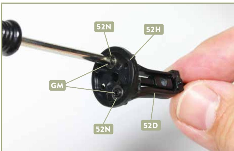
**11** Befestigen Sie die Schieberstangenführung **52D** an dem Deckel **52H**: Platzieren Sie dazu zunächst je eine Unterlegscheibe **52N** auf zwei Schrauben **GM** und drehen Sie diese dann fest.
