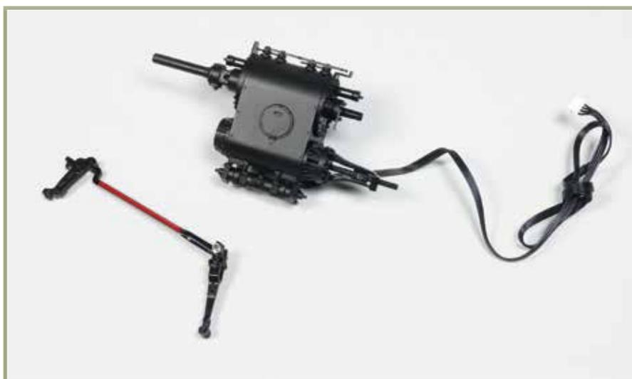
Die Arbeiten am rechten Zylinderblock sind vorangeschritten. An der rechten Schieberschubstange wurden der Voreilhebel und die Schwinge angebracht.
