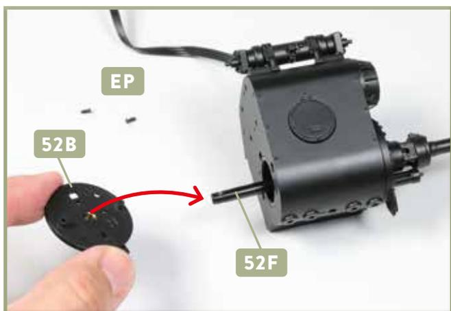
**3** Setzen Sie den hinteren Zylinderdeckel **52B** auf den Zylinderblock, wobei die zentrale Bohrung des Deckels über die Kolbenstange **52F** geführt wird, wie es der Pfeil andeutet. Legen Sie zwei Schrauben **EP** bereit.
