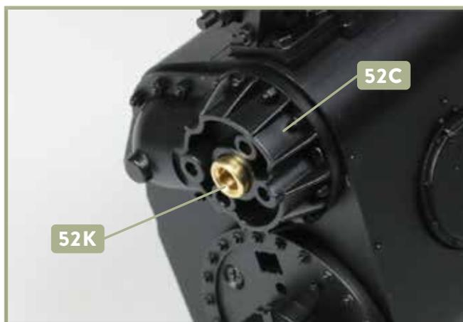
**8** Setzen Sie den Messingring **52K** in die Aufnahme des Schieberkastendeckels **52C**.
