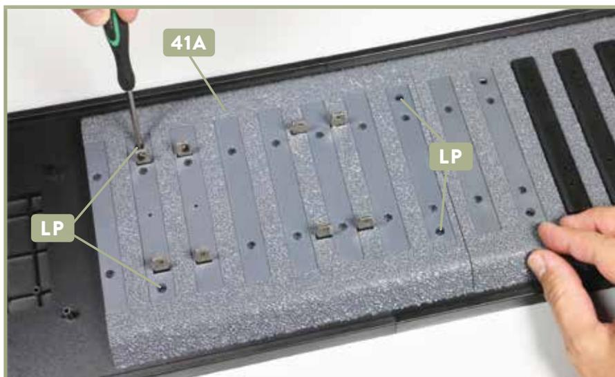
**3** Fixieren Sie die Bettung 41A mit den vier Schrauben LP an der Bodenplatte.
