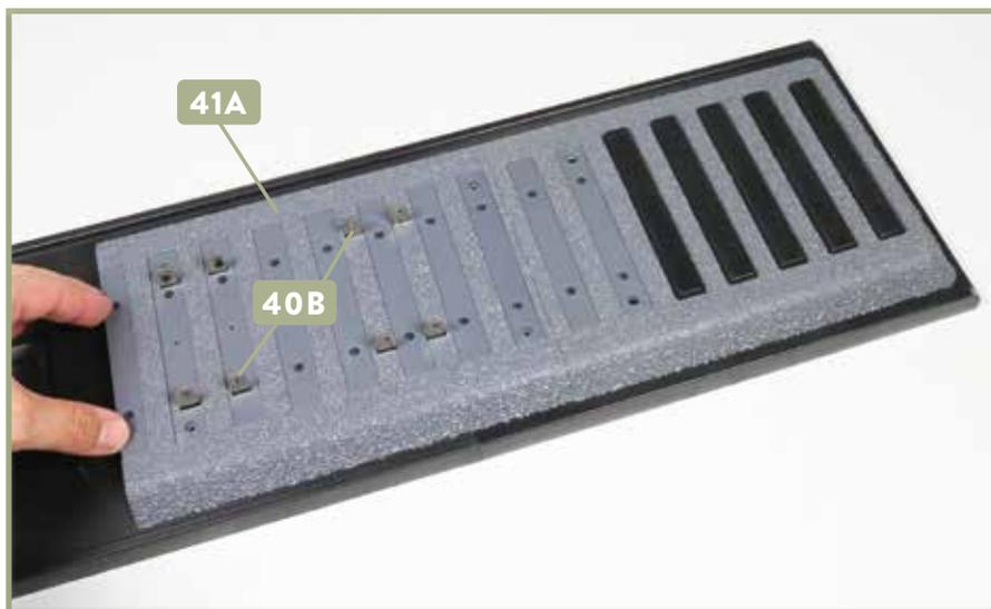
**2** Die Bettung 41A ist korrekt auf der Bodenplatte platziert: In ihren Schlitzen sitzen die Laschen der beiden Schienenrollen-Halterungen 40B.
