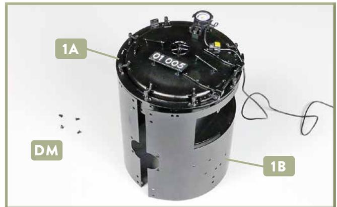
**2** Die Türwand-Baugruppe 1A ist vorne in die Rauchkammer 1B eingefügt. Legen Sie vier Schrauben DM bereit.
