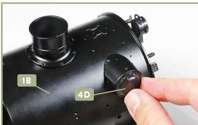
**5** Versehen Sie die Zapfen an der Innenseite vom Deckel 4D mit Sekundenkleber und fixieren Sie das Teil an der rechten Seite der Rauchkammer 1B.
