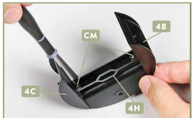
**6** Befestigen Sie den Verschlussbalken **4H** mit den beiden Schrauben **CM** an den Rauchkammernischen **4B** und **4C**.
