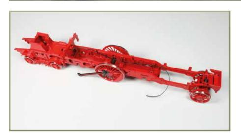
Die hintere Rauchkammerstütze ist mit einer Abdeckung versehen und in den Barrenrahmen eingefügt.
