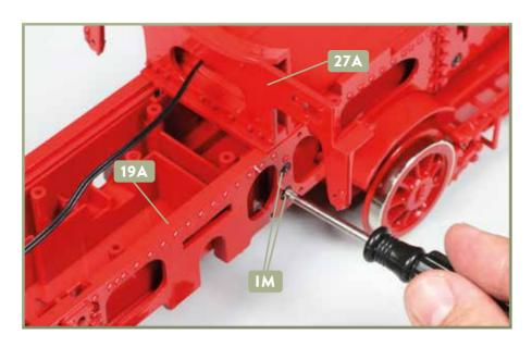
Fixieren Sie die Rauchkammerstütze 27A mit zwei Schrauben IM an der rechten Rahmenwange 19A, wie abgebildet.
