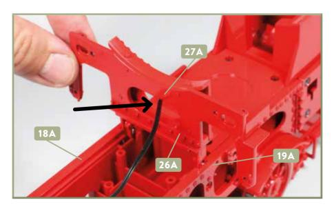
3 Fügen Sie die Rauchkammerstütze 27A so zwischen den beiden Rahmenwangen 18A und 19A ein, dass die Schraubenaufnahmen der Teile fluchten. Führen Sie dabei das Lautsprecherkabel 26A durch die zentrale Öffnung der Rauchkammerstütze, auf die der Pfeil weist.
