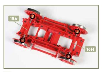
4 Fügen Sie den vorderen Laufradsatz 15A und anschließend den hinteren Laufradsatz 16H in den Rahmen des Drehgestells ein. Achten Sie dabei darauf, dass sich die schwarz umkreisten Hülsen der beiden Radsätze an den abgebildeten Stellen befinden!
