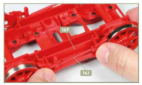
10 Wechsel auf die linke Seite des Drehgestells: Nehmen Sie das linke Bremsgestänge 16J und befestigen Sie es an der linken Abdeckung 16F. Dazu werden seine zwei Zapfen vorsichtig in die entsprechenden Bohrungen hineingedrückt.
