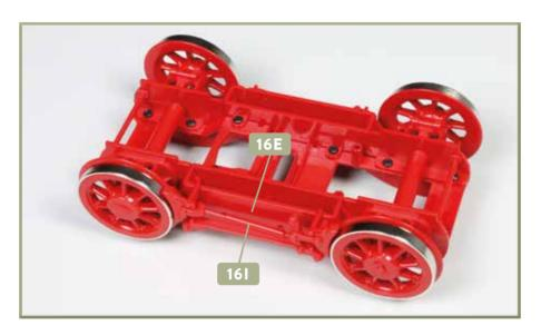
9 Auf der rechten Seite des Drehgestellrahmens wird das rechte Bremsgestänge 161 befestigt. Fügen Sie dazu dessen zwei Zapfen in die entsprechenden Bohrungen der rechten Abdeckung 16E ein.
