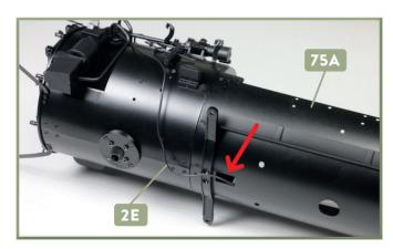
5 Führen Sie den Stecker und das Kabelende von 2E durch die rechteckige Öffnung an der Unterseite des Langkessels 75A, auf die der Pfeil weist.
