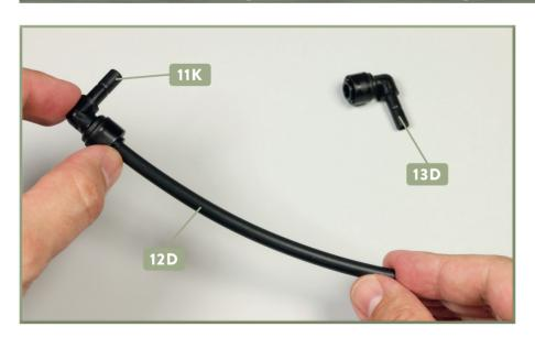
Legen Sie die Wasserabführung 13D bereit. Nehmen Sie die Wasserleitung 12D und lösen Sie die daran befestigte Wasserabführung 11K, indem Sie leicht gegen den inneren Verschlussring der Wasserabführung drücken, wie angedeutet.
