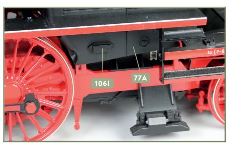
3 Jetzt werden die beiden Schmiermittelbehälter festgeklebt: 1061 (mit aufgeprägtem "A") gehört unten an die linke Seitenwand des Stehkessels 77A, 106F (mit aufgeprägtem "B") an die rechte Seitenwand des Stehkessels 78A (Detailbild).
