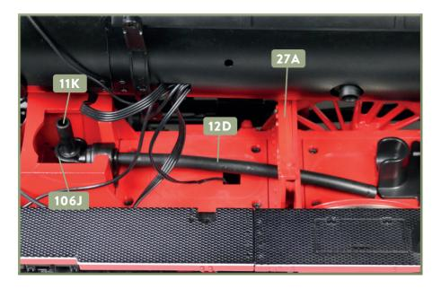
Führen Sie das hintere Ende der Wasserleitung 12D durch die Öffnung in der hinteren Rauchkammerstütze 27A. Die am vorderen Ende der Wasserleitung angebrachte Wasserabführung 11K wird in die vordere Halterung 106J eingefügt.
