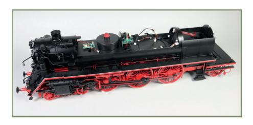
Die Bodenteile sind am Langkessel angebracht. Die Wasserleitung ist verlegt. Der Steh- und der Langkessel sind verschraubt und am Modell montiert. Auf der linken Seite des Modells sind Dampfleitungen befestigt.
